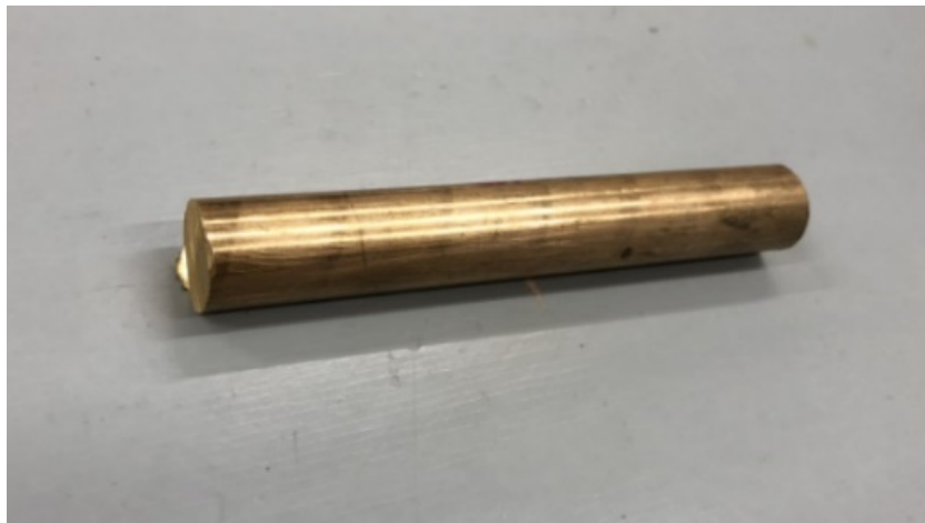
Obrázek č. 3: Polotovar – mosazná kulatina (zdroj vlastní)
