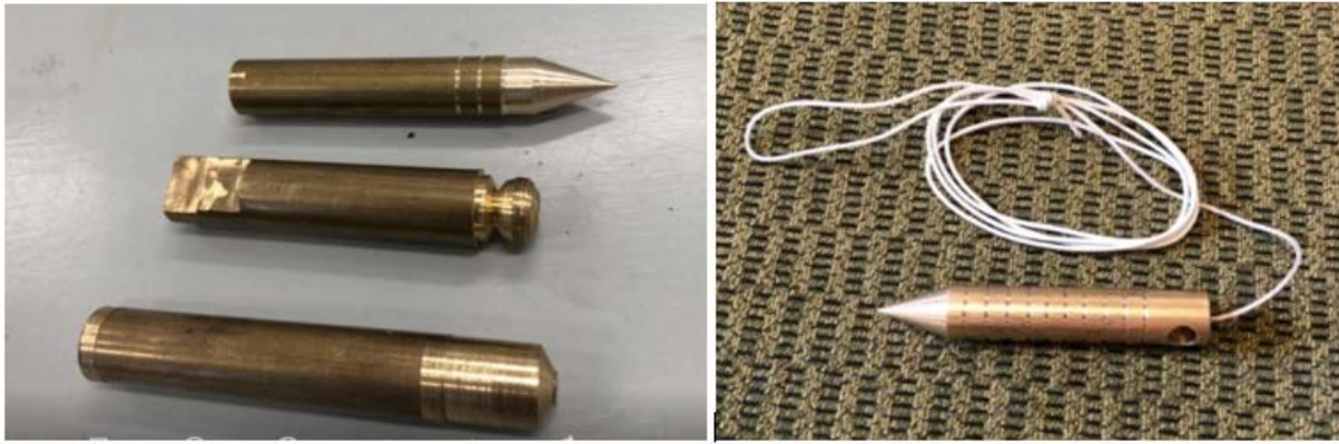
Obrázek č. 4: Obrobky v procesu obrábění; výrobek po obrobení (zdroj vlastní)
