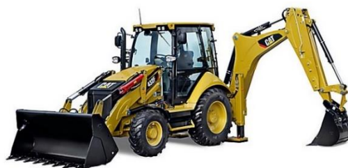
Obr. 8-6: Rypadlo - nakladač Caterpillar 432F
