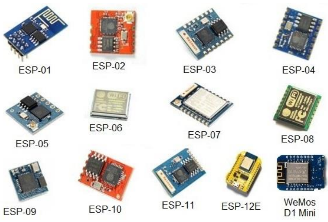
Obrázek 3 - Přehled čipů ESP8266 [12]
