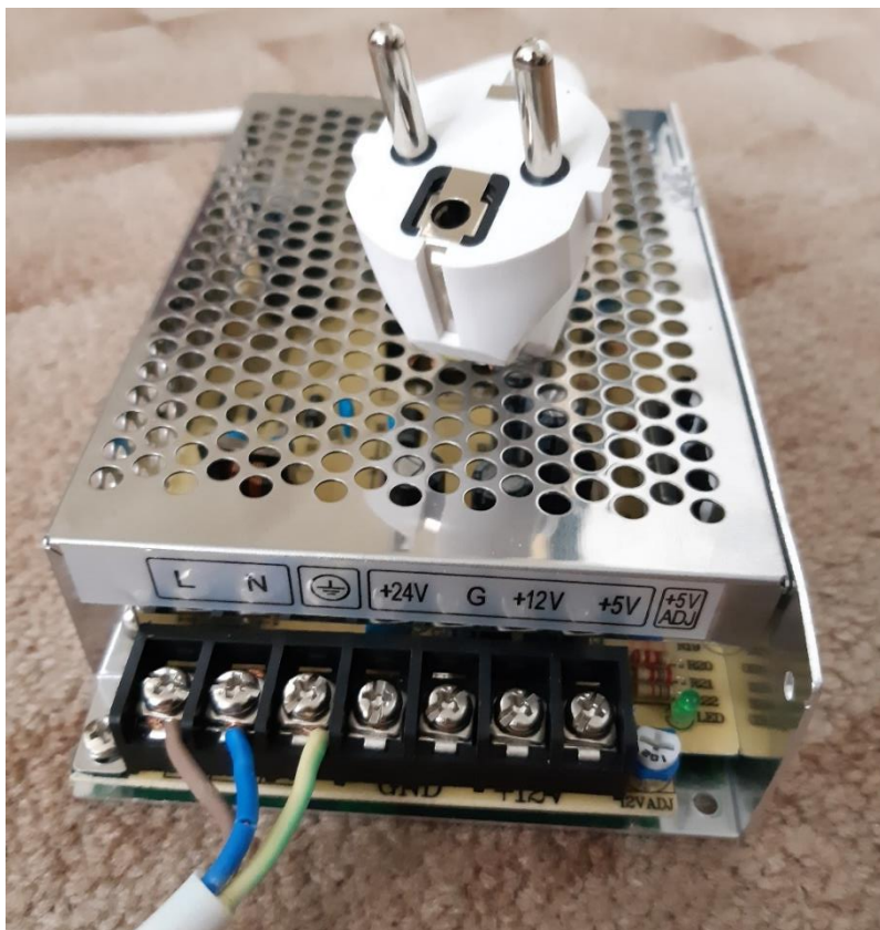
Obrázek 36 - Napájecí zdroj s vyhotovenou kabeláží
