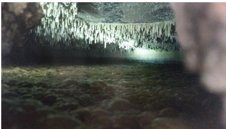
Obrázek 1 - Síra na stěnách fermentoru
