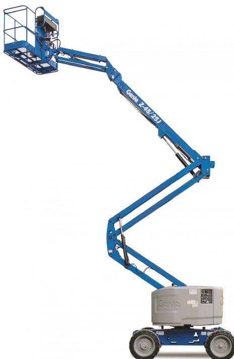
Obrázek 64 - Kloubová pracovní plošina GENIE Z45/25-16 m [47]
