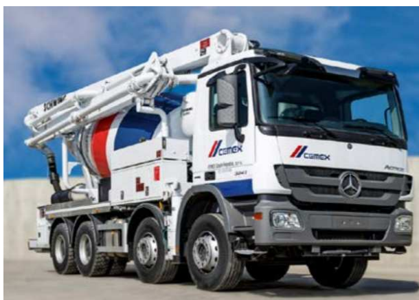
Obrázek 66 - Autodomíchávač s čerpadlem Pumpomix [50]
