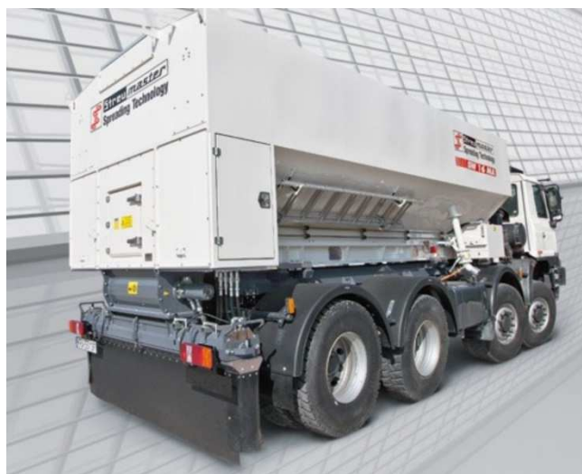
Obrázek 45 - Dávkovač pojiv MAN STREUMASTER SW16MC [26]
