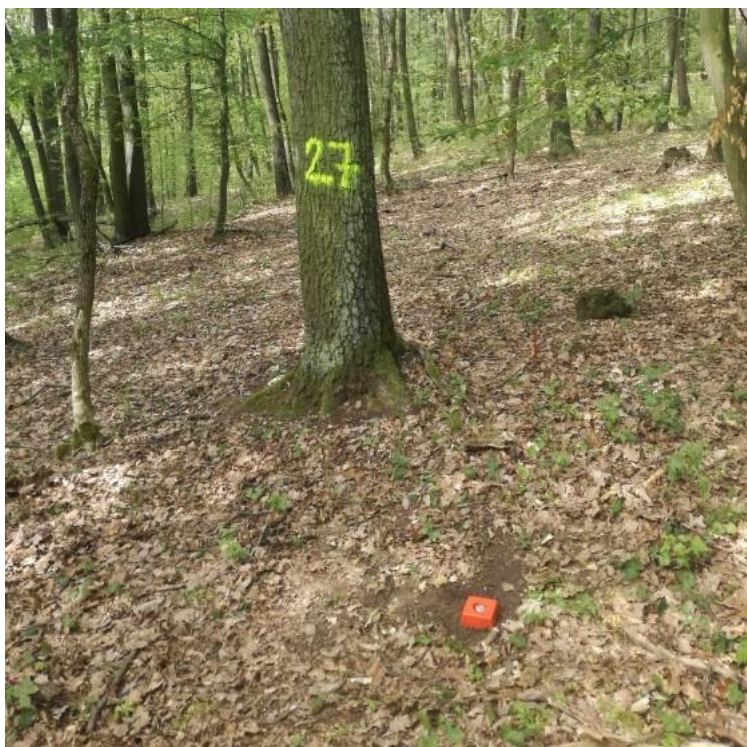
Obrázek 2: Označení stromů a umístění geodetických bodů Zdroj: Krupičková (2020)
