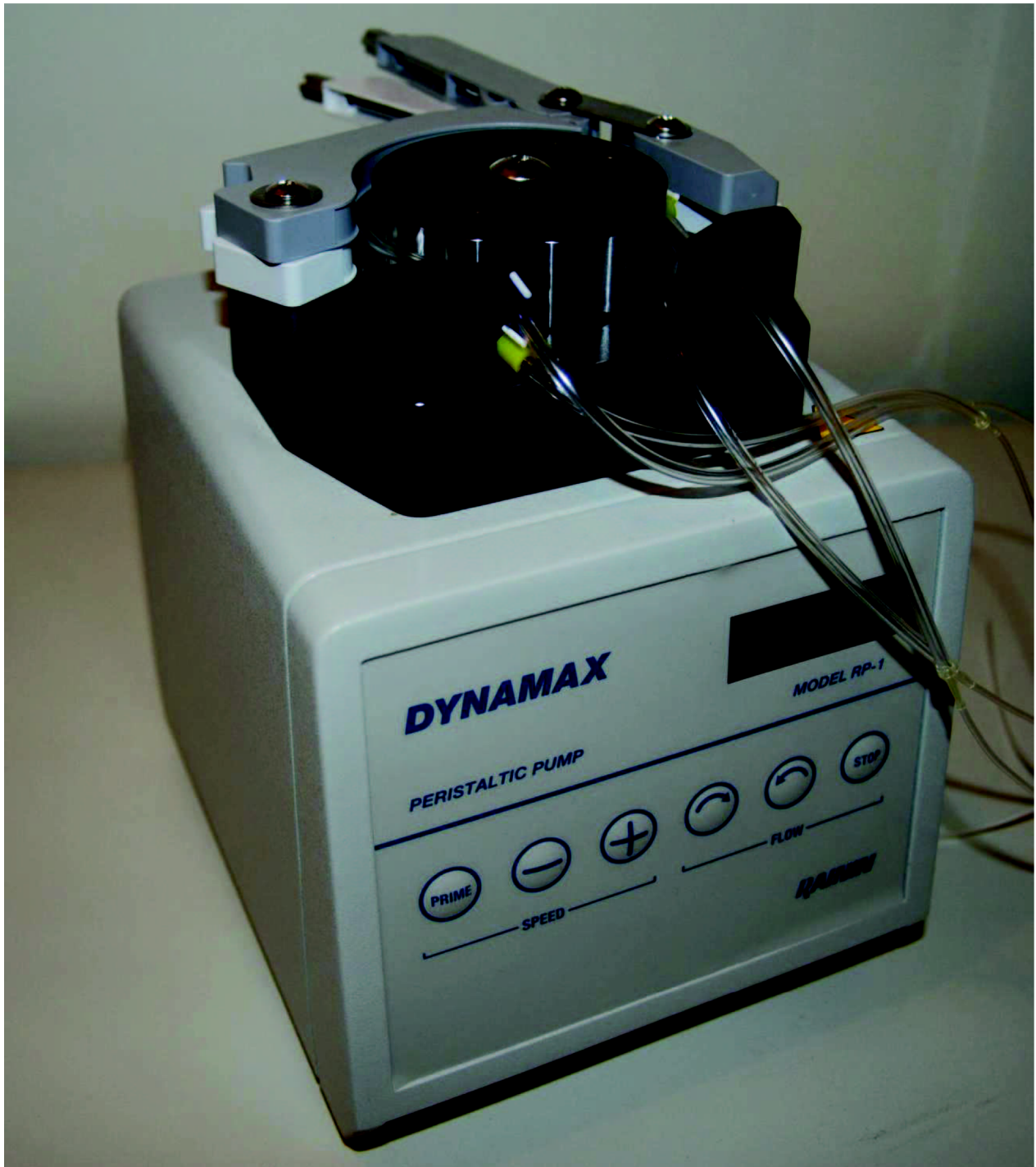
Obrázek 2.1: Peristaltická pumpa Rainin Dynamax RP-1. [fografie z archivu autora]
