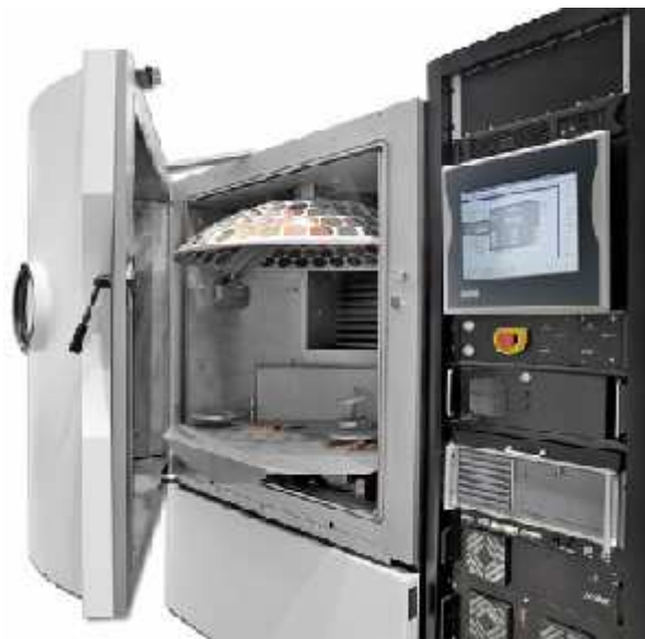
Obr.32: Vakuové napařovačky s uložením na segmentový kolotoč (Převzato z [21])
