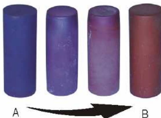
Obr.35: LaB_6 (LanthanBoridová) katoda, která je součástí plazmového zdroje nasunutá na grafitový heater (topič) (viz. kap. 6.3. obr.18). Na obrázku je vidět postupné opotřebení katody (Převzato z [6]).
