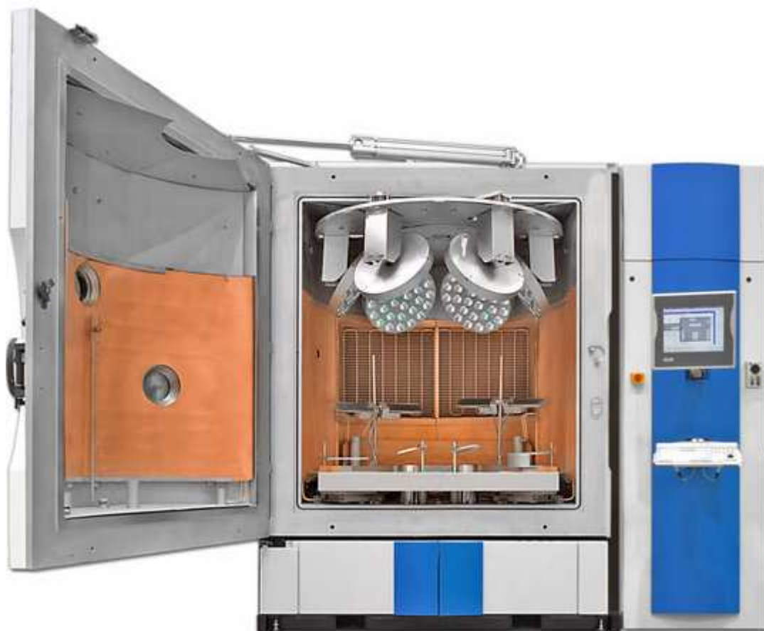
Obr.33: Vakuová napařovačka s planetárním uložením (Převzato z [21])
