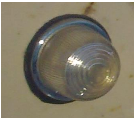
Obr. 68 Bílé provedení směrových světel
