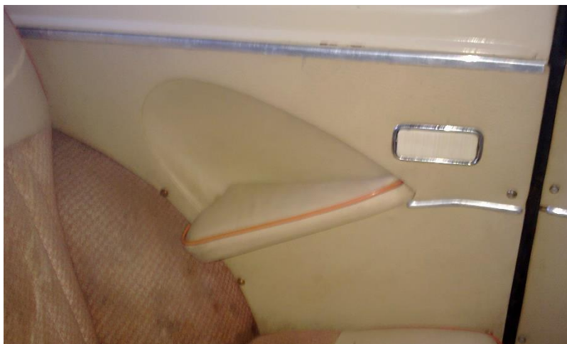
Obr. 80 Čalounění boční stěny
