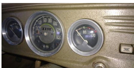
Obr. 75 Povrchová úprava přístrojového štítu
