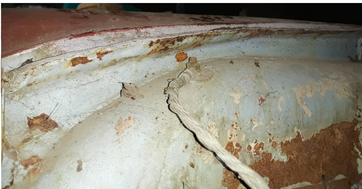
Obr. 91 Přední podběh poškozený dlouhým svarem
