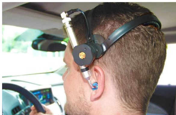
Obr. 59 Binaurální sluchátka BHM III.3: Mobile ICP od společnosti HEAD acoustics [102]
