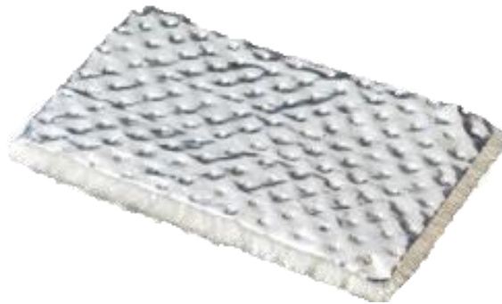
Obr. 43 Perforovaná hliníková fólie aplikovaná na skelné vlákno [90]
