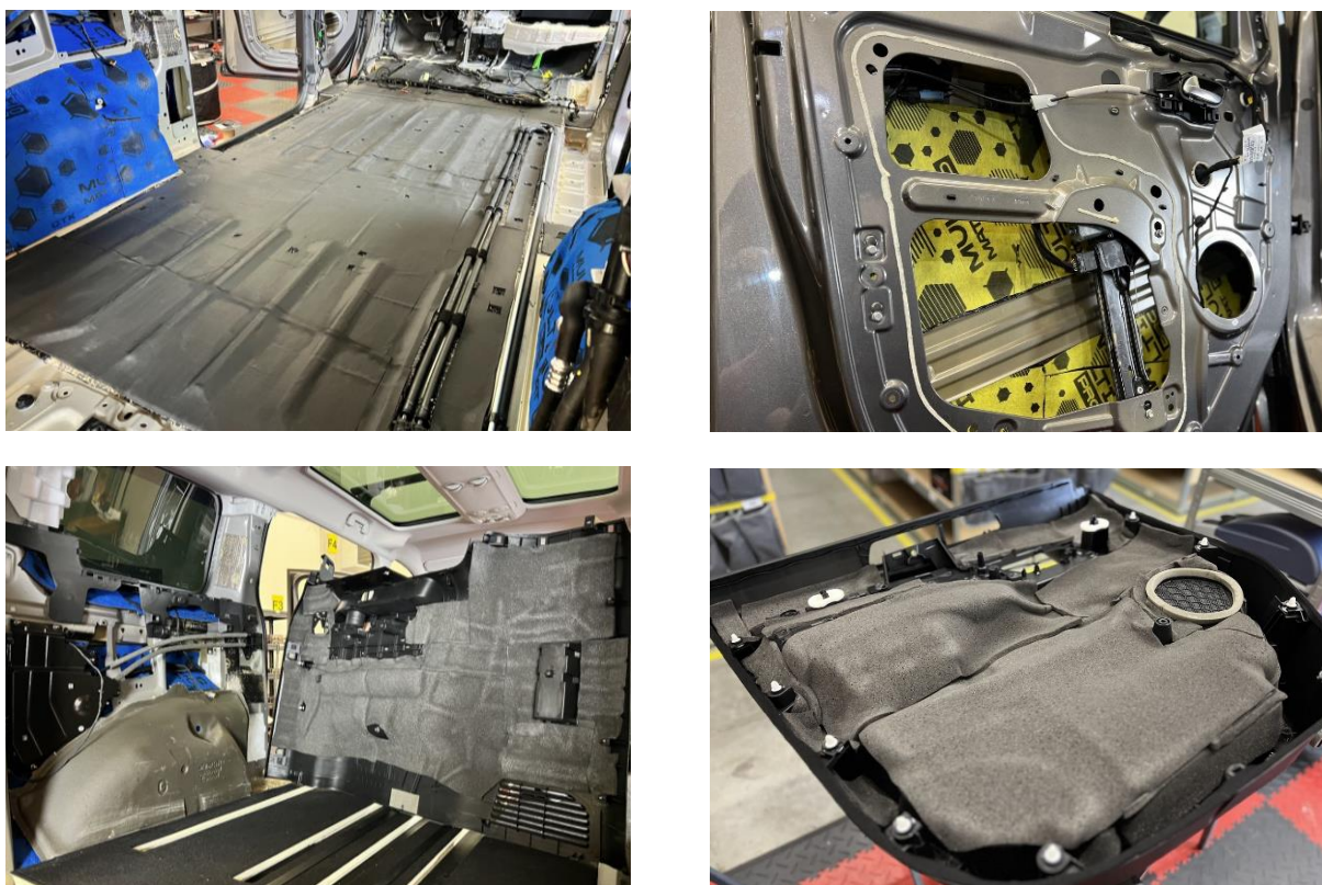
Obr. 74 Aplikace zvuk pohlcujících materiálů na různé části automobilu
