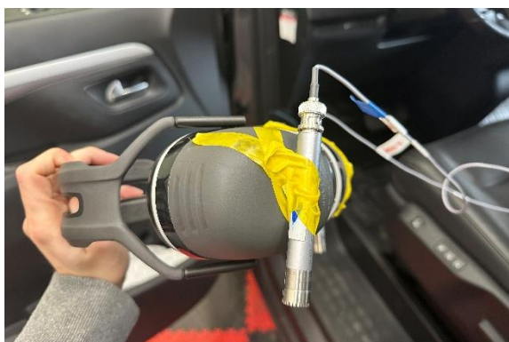
Obr. 71 Rozmístění jednotlivých mikrofonů v interiéru vozidla
