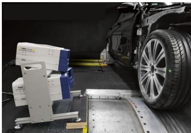
Obr. 11 Měření vibrací pneumatik na válcovém dynamometru za pomoci laserového vibrometru [41]
