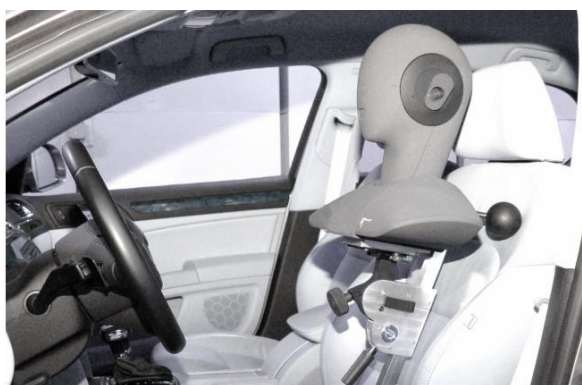
Obr. 60 Umělé torzo hlavy včetně ramen HSU III od společnosti HEAD acoustics [105]
