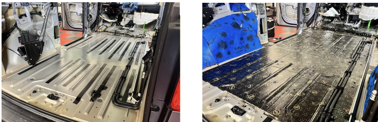
Obr. 73 Aplikace vibrace tlumicího materiálu na podlahu
