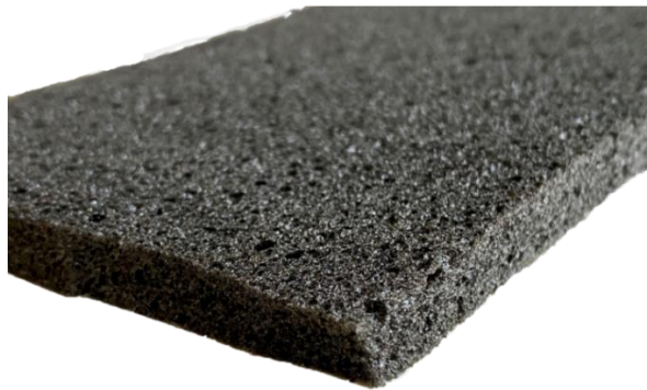
Obr. 40 Struktura polyuretanové pěny STP Biplast
