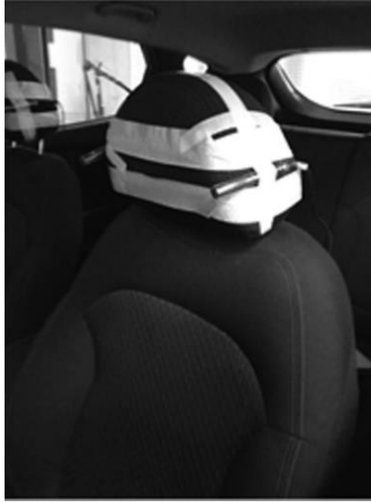
Obr. 56 Umístění mikrofonů na hlavovou opěrku řidiče [25]
