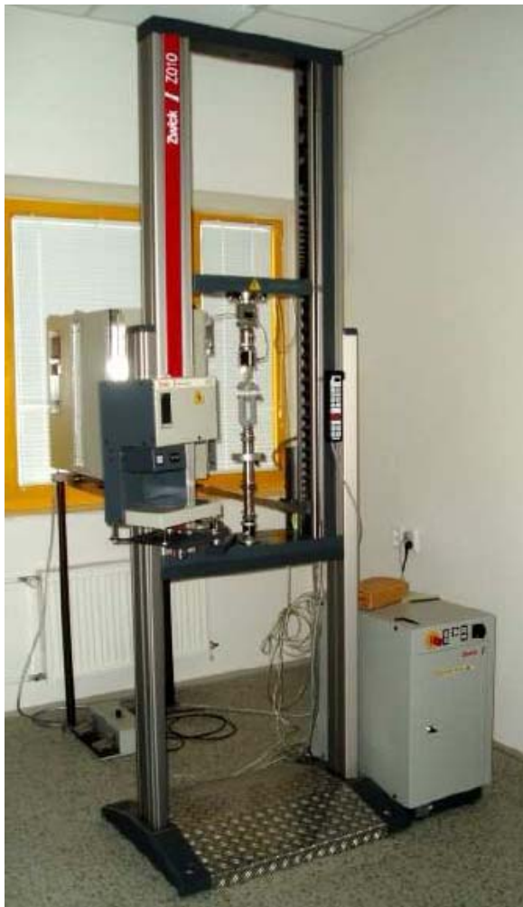
Obr. 24, 25: Testovací zařízení Zwick a upevnění modelového vzorku do čelistí měřicího aparátu.
