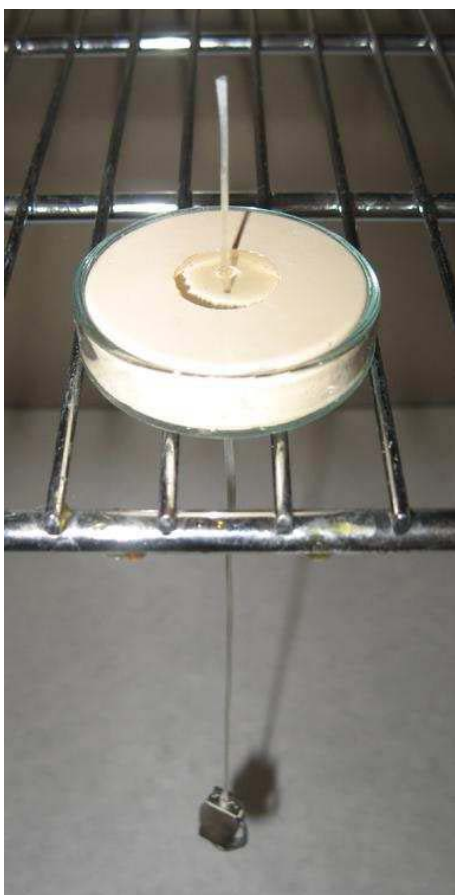
Obr. 23: Příprava polymerního tělíska na svazku vyztužujících vláken.
