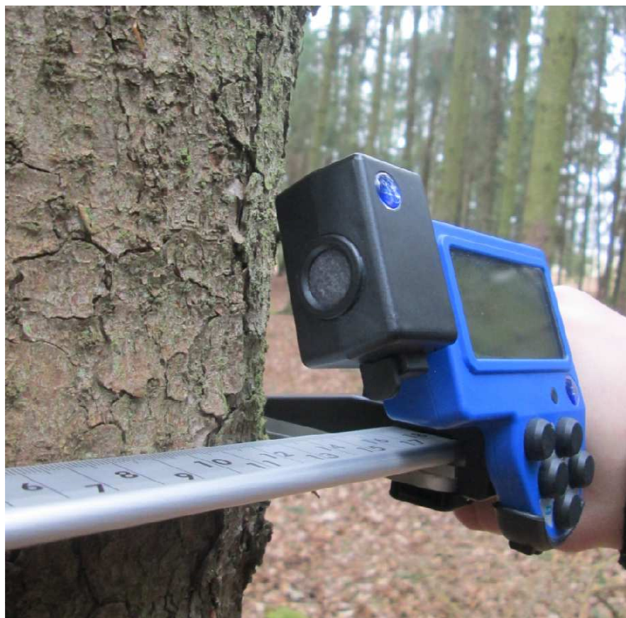
Obrázek 32: Zařízení DP DME pro měření vzdáleností pomocí ultrazvuku
