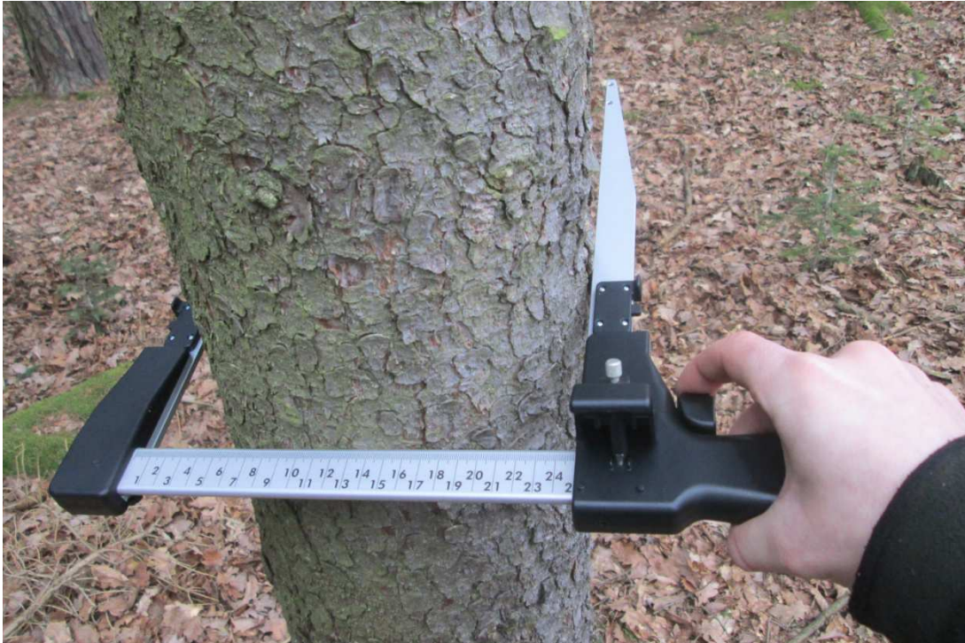
Obrázek 36: Registrace dat bez připevněného počítačového terminálu DP11 s využitím DP Radio
