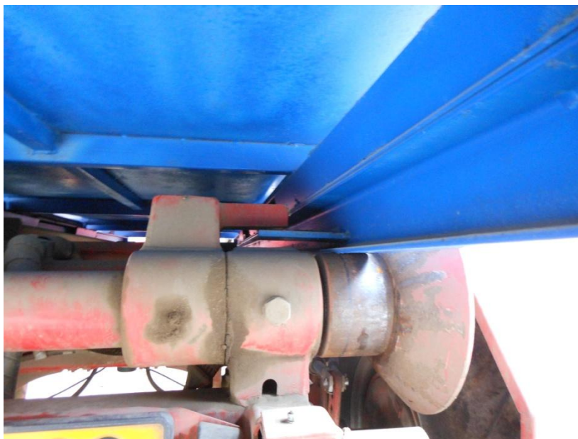
Obr. 18: Zajištění plošiny při přepravě (Foto: Antonín Tůma)
