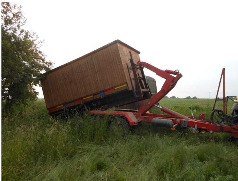
Obr. 16: Natahování plošiny na kontejnerový nosič (Foto: Antonín Tůma)
