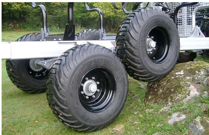
Obr. 29: Chování nápravy při průjezdu přes nerovnosti (FOREST MERI 2017)
