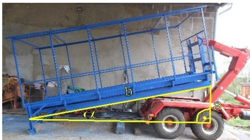
Obr. 20: Největší úhel při natahování plošiny (Foto: Antonín Tůma)
