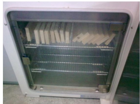
Obr. 56 a 57: Laboratorní sušárna INCUCELL 55 a uložení vzorků pro dosažení nulové vlhkosti.
