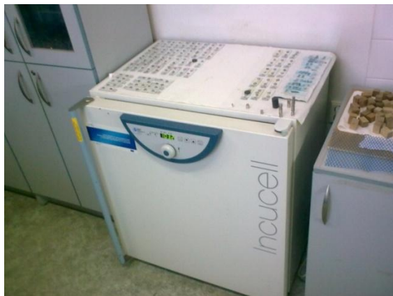
Obr. 56 a 57: Laboratorní sušárna INCUCELL 55 a uložení vzorků pro dosažení nulové vlhkosti.
