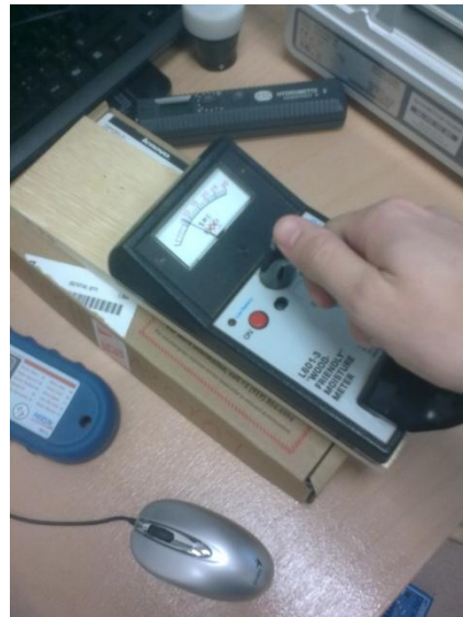
Obr. 60 a 61: Měření vlhkosti přístroji Elbez WHT-740 a Wagner L601-3
