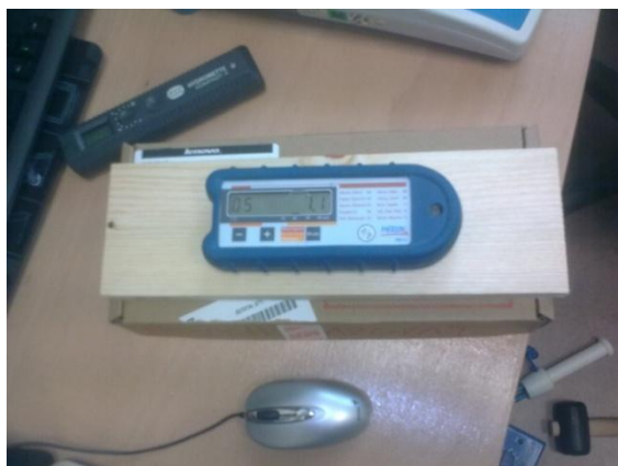
Obr. 58 a 59: Měření vlhkosti přístroji Merlin PMI-E a Gann Hydromette Compact A
