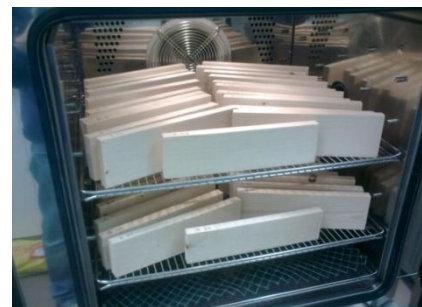
Obr. 62, 63 a 64: Klimatizační komora MEMMERT CTC 256, ovládací panel klimatizační komory a uložení vzorků pro klimatizování.
