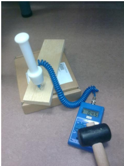
Obr. 60 a 61: Měření vlhkosti přístroji Elbez WHT-740 a Wagner L601-3
