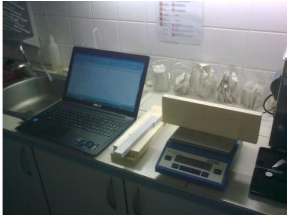
Obr. 54 a 55: Zjišťování hmotností a rozměrů vzorků v absolutně suchém stavu.
