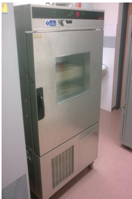
Obr. 62, 63 a 64: Klimatizační komora MEMMERT CTC 256, ovládací panel klimatizační komory a uložení vzorků pro klimatizování.
