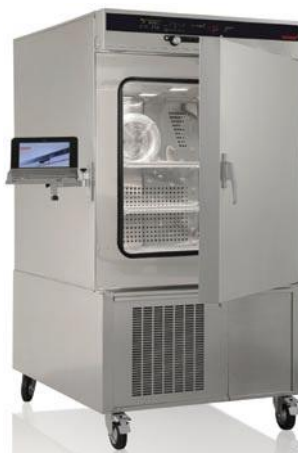
Obr. 21: Laboratorní klimatizační komora MEMMERT CTC 256 ( www.memmert.com )
