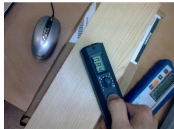
Obr. 58 a 59: Měření vlhkosti přístroji Merlin PMI-E a Gann Hydromette Compact A
