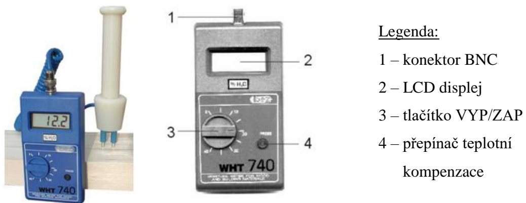
Obr. 24: Pohled a popis přístroje Elbez WHT-740 ( www.elbez.cz )
