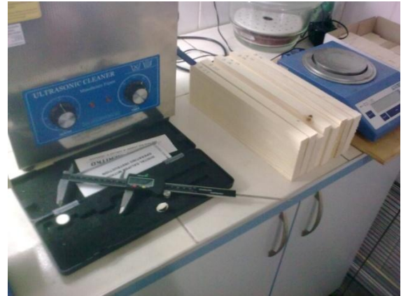
Obr. 54 a 55: Zjišťování hmotností a rozměrů vzorků v absolutně suchém stavu.
