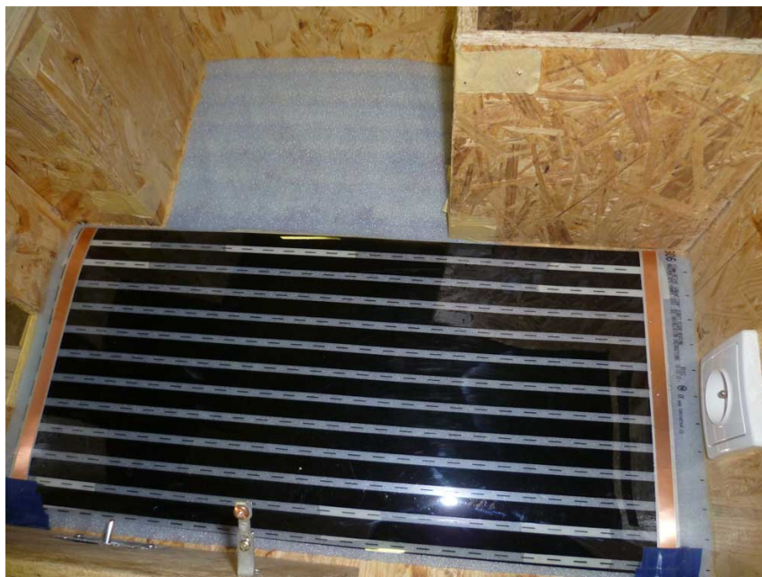
Obrázek 7: Náhled na provedení vytápení a jeho izolaci
