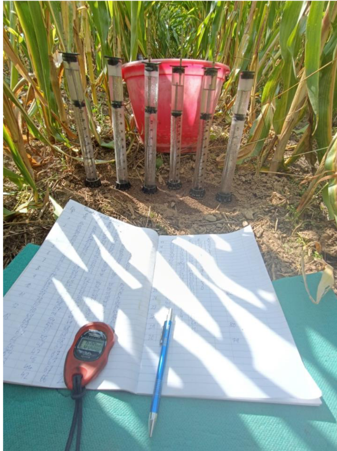
Obr. 8: Terénní měření pomocí minidiskových infiltrometrů
