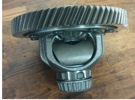
Obrázek 9.2: Uzavření mechanického diferenciálu převodovky
