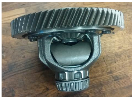
Obrázek 9.2: Uzavření mechanického diferenciálu převodovky
