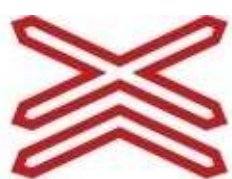
Výstražný kříž pro železniční přejezd vícekolejný
