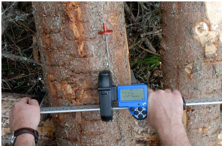
Obrázek 7 postup měření při kalibraci harvestoru (3)
