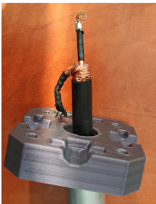
Obr. 4.8: Příprava koax. kabelu.
