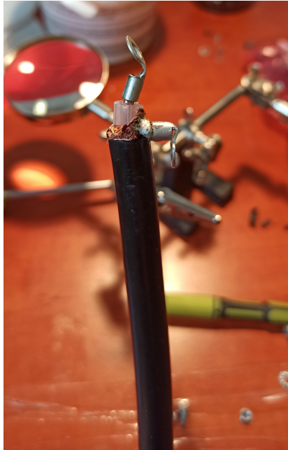
Obr. 5.2: Zapravení koax. kabelu. Foceno před zaizolováním.
