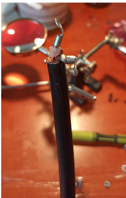
Obr. 5.2: Zapravení koax. kabelu. Foceno před zaizolováním.
