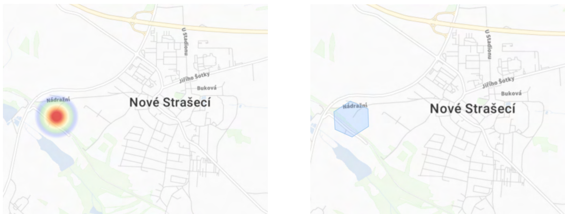
Obrázek 16: Převedení z jednotlivých identifikátorů buňky na GPS lokaci – ukázka v rámci vizualizace v mapových podkladech. Zdroj: vlastní zpracování, 2024.
