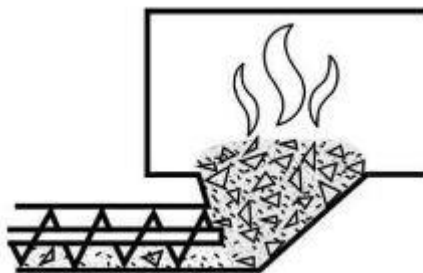
Obr. 4-1 Spalování se spodním přívodem paliva[21]
