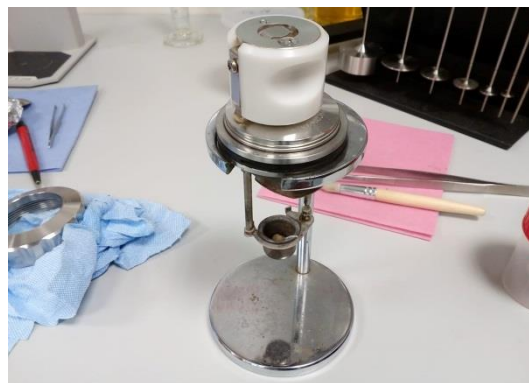
Obr. 5-5 Držák s víkem rozkladné nádoby, k víku je zapojen zapalovací adaptér
