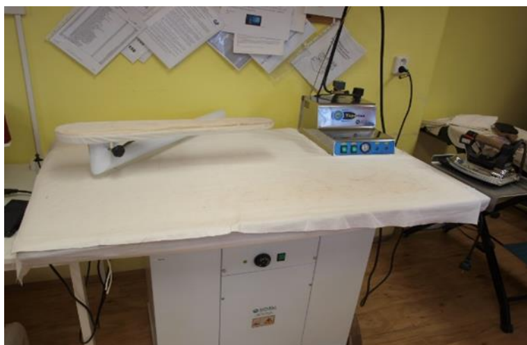
Obrázek 4: Žehlicí stůl s odsáváním par a parní žehličkou
