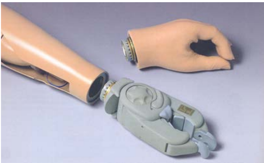
Obr. 20 Elektrická ruka a pracovní násadec [30]
