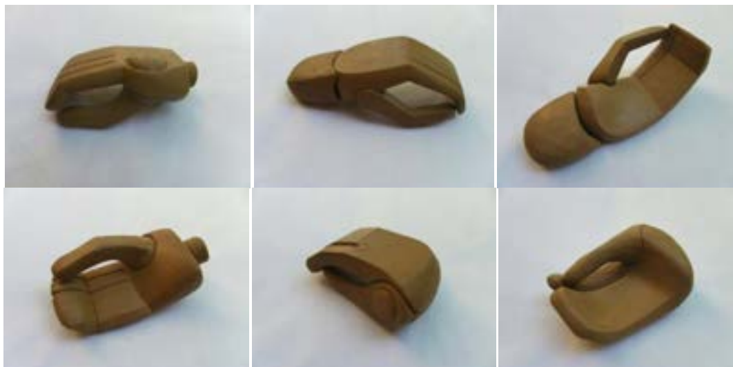
Obr. 81 Hmotová studie druhého konceptu – modely chapadel a lůžek z claye
