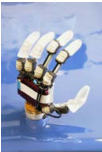
Obr. 39 Hydraulicky poháněný úchop chapadla [49]
