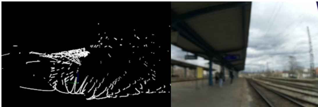
Obr. 3.11: Porovnanie mračna bodov s obrázkom z kamery (Brno-Židenice)
