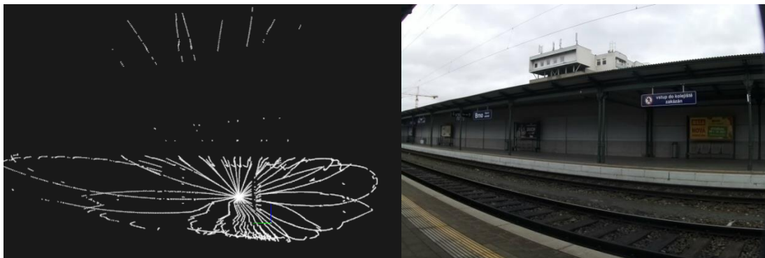
Obr. 3.10: Porovnanie mračna bodov s obrázkom z kamery (Brno-Hlavní nádraží)
