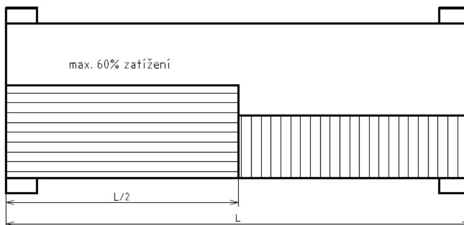
Obr. 1-4: Rozdělení zátěže u kontejneru ISO řady 1 [3]
