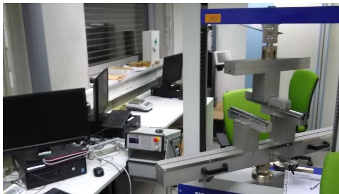
Obrázek č. 12 Měřicí stroj TIRA test 2850 S
