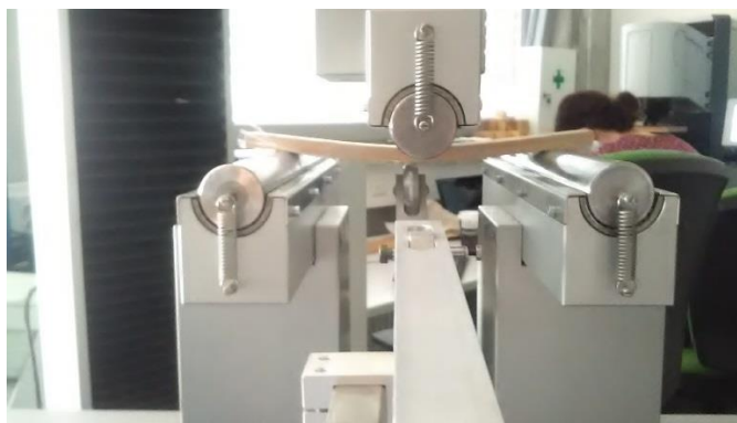
Obrázek č. 14 Vkládání vzorku na podpěry
