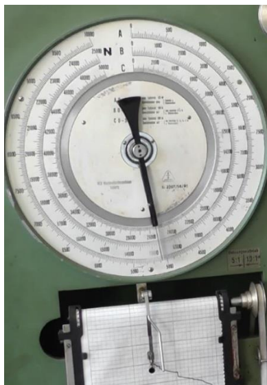
Obrázek č. 2 Záznam hodnot silovo-průhybového diagramu
