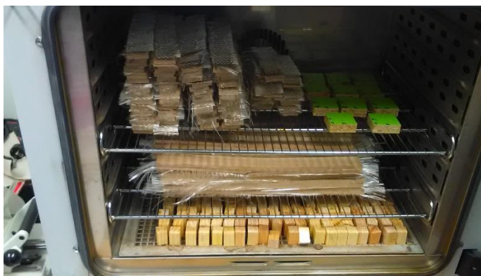
Obrázek č. 15 Sušárna Binder ED 23
