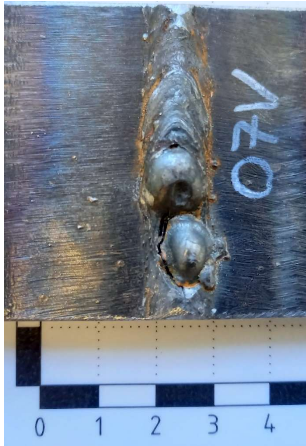
Obr. P.1 Vzorek 07 po únavové zkoušce
