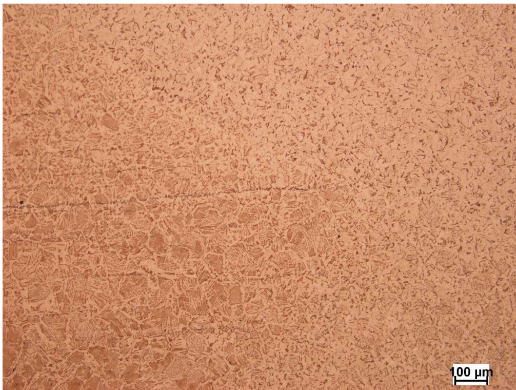
Obr. P.20 SK+vyžíhaná část SK a TOO – 09-01
