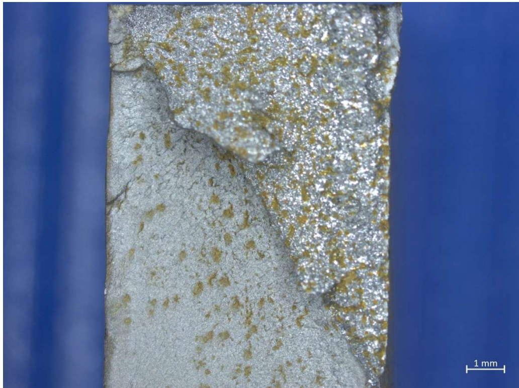
Obr. P.19 Únavový lom 09 - B
