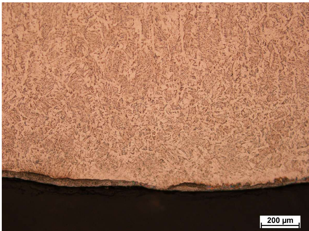
Obr. P.22 Svarový kov - 09-03
