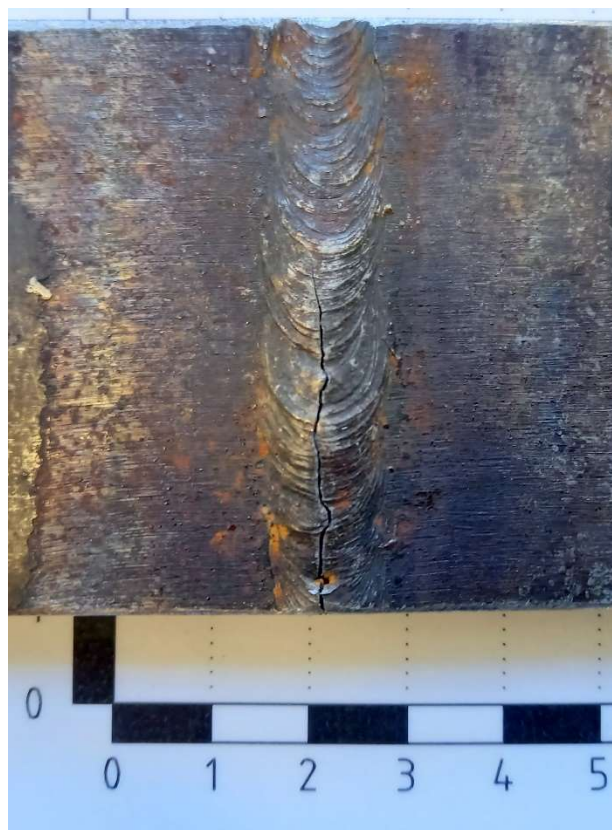
Obr. P.9 Vzorek 08 po únavové zkoušce
