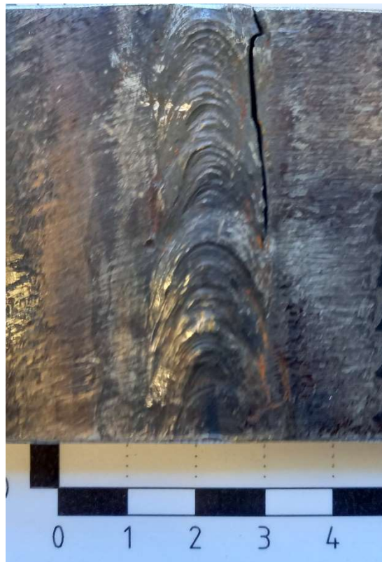
Obr. P.17 Vzorek 09 po únavové zkoušce
