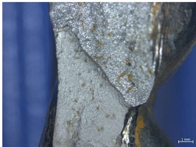
Obr. P.2 Únavový lom - vzorek 07
