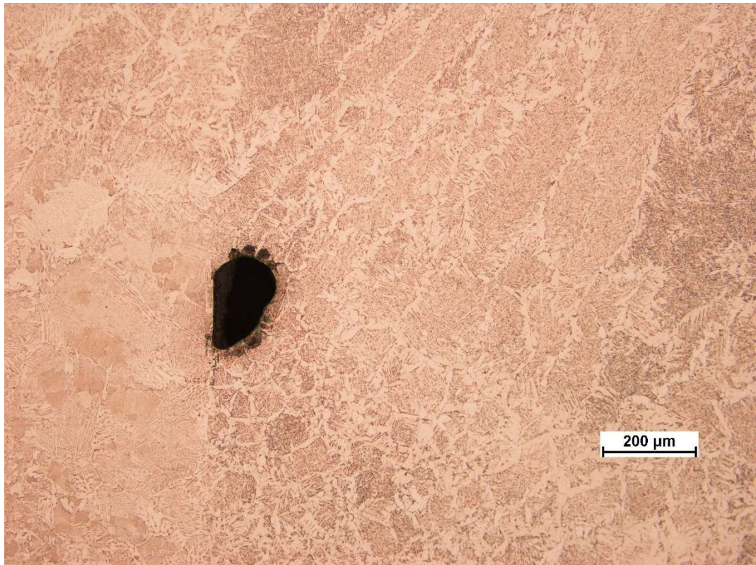
Obr. P.15 Přejchod mezi svarovým kovem a TOO - 08-04
