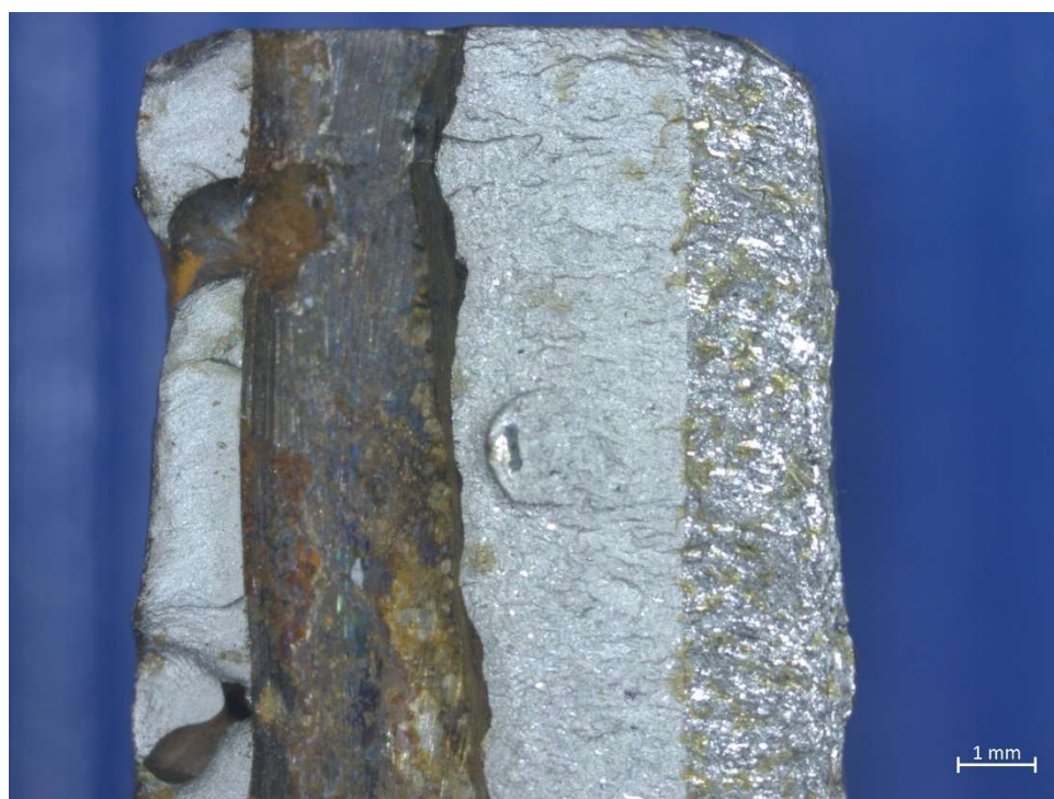
Obr. P.10 Únavový lom vzorek 08 - A
