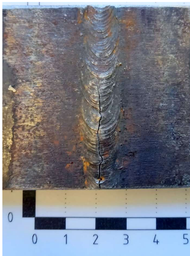
Obr. P.9 Vzorek 08 po únavové zkoušce
