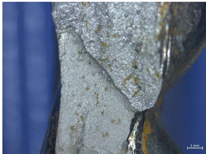
Obr. P.2 Únavový lom - vzorek 07
