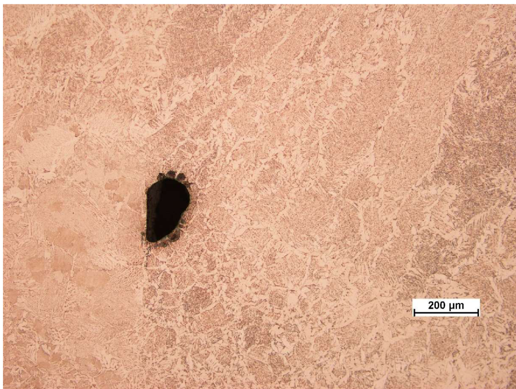
Obr. P.15 Přechod mezi svarovým kovem a TOO - 08-04
