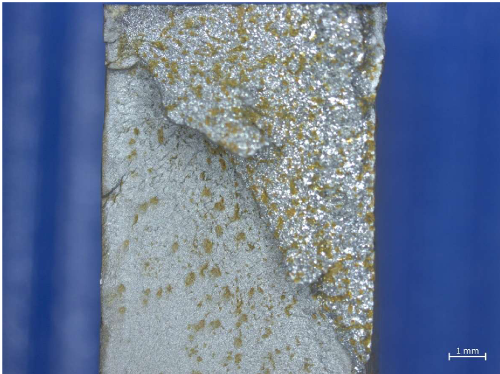
Obr. P.19 Únavový lom 09 - B
