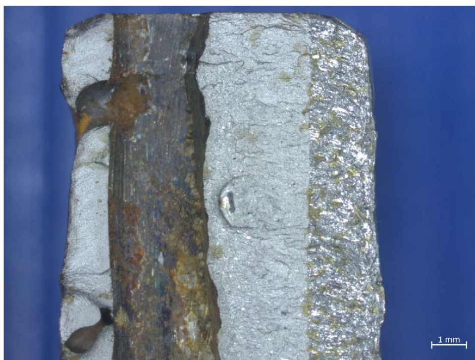
Obr. P.10 Únavový lom vzorek 08 - A
