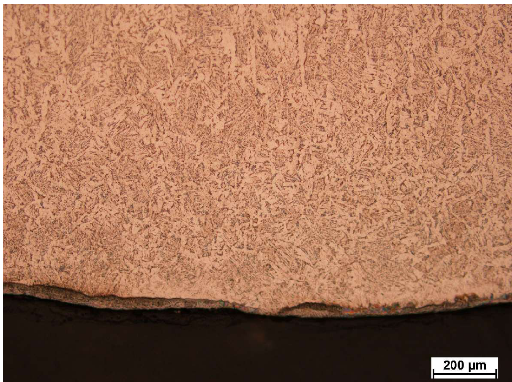
Obr. P.22 Svarový kov - 09-03
