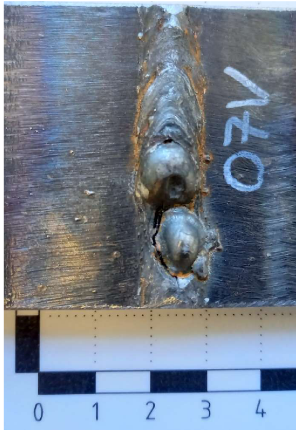
Obr. P.1 Vzorek 07 po únavové zkoušce
