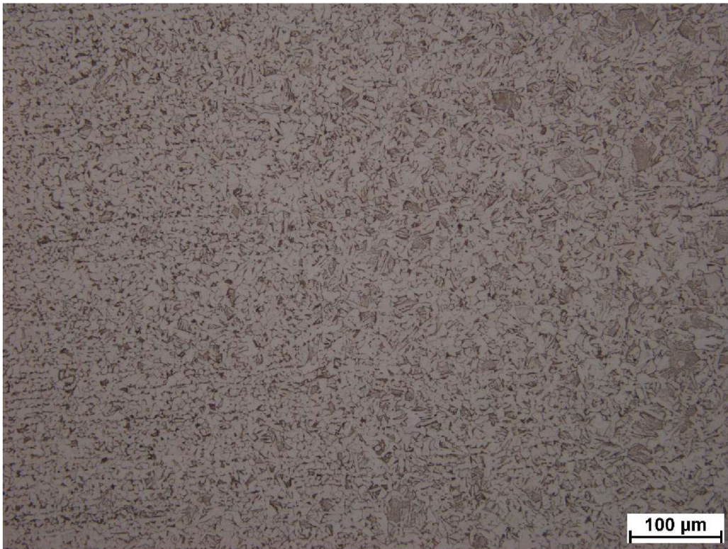
Obr. P.5 Přechod TOO do pásma přehřátí - 07-03
