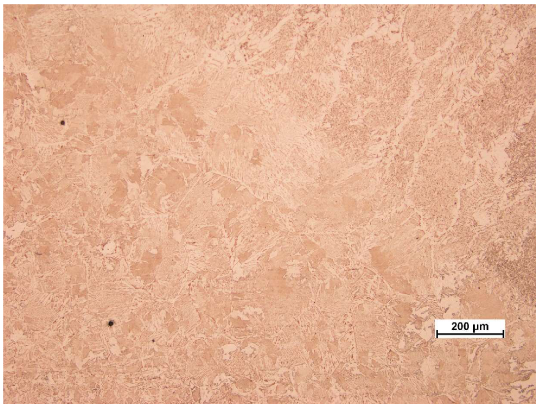
Obr. P.13 Přechod mezi TOO a svarovým kovem – 08-02
