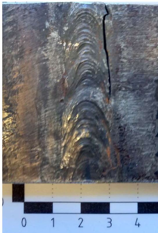
Obr. P.17 Vzorek 09 po únavové zkoušce
