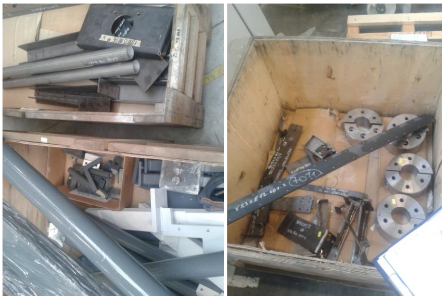
Obr. 21: Materiál vychystaný na lakovanie rozdelený podľa a) požadovanej farby, b) projektu.
