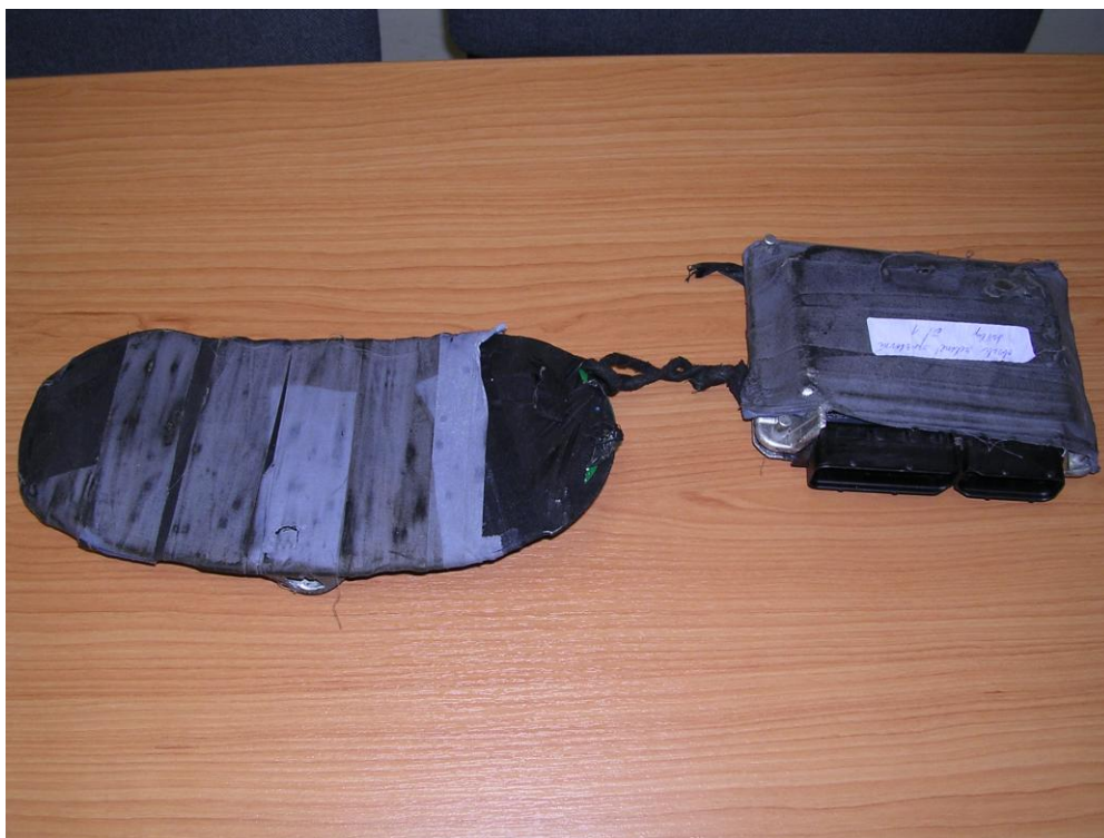
obr. č. 4 – přípravek pro krádeže vozidel tzv. „budíky“ s propojenou řídicí jednotkou
