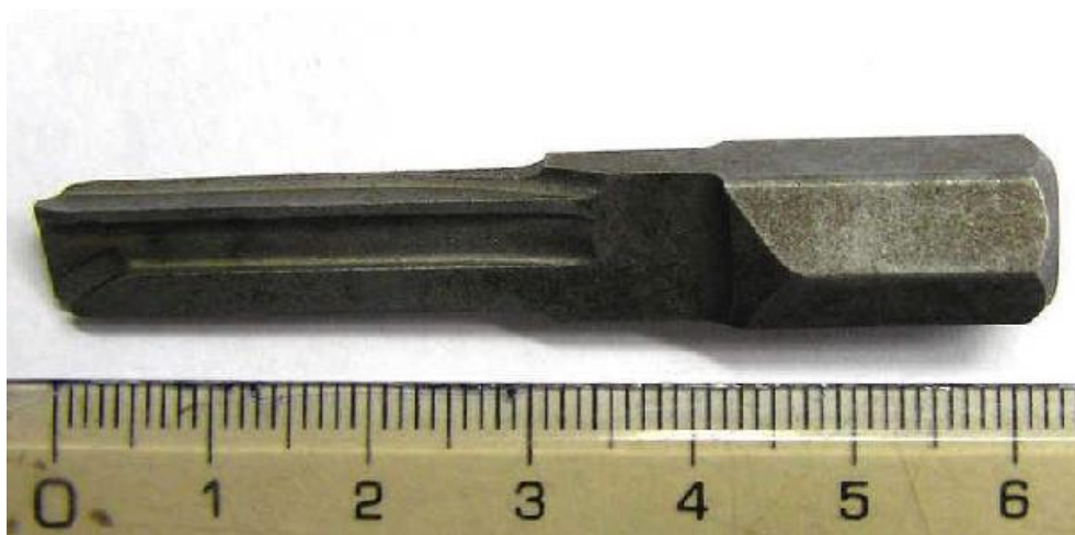
obr. č. 3 – přípravek ke krádeži vozidel tzv. „rozlamovák“ zámků popř. spínací skříňky
