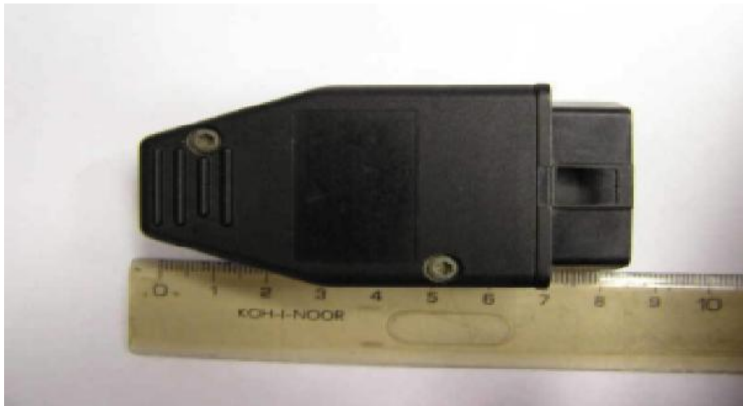
obr. č. 1 – přípravek pro krádež vozidla (elektronická krabička k nastartování vozidla)
