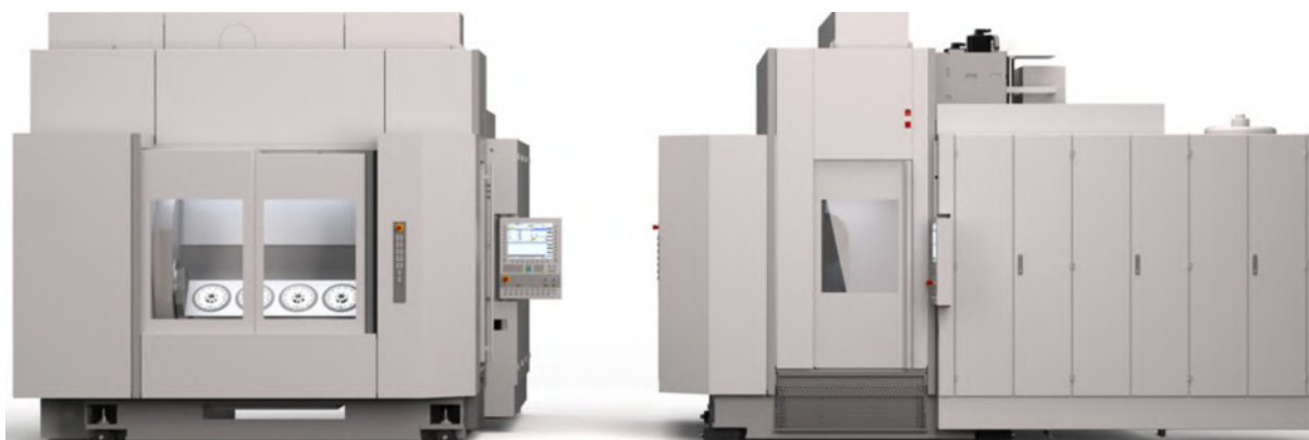
Obr. 12) Čtyřvřetenové obráběcí centrum [19]
