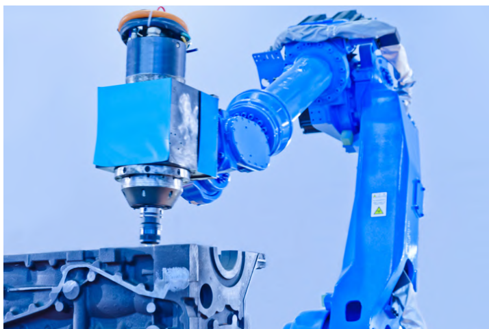
Obr. 3) Odjehlovací nástroj jako koncový efektor robota [7]
