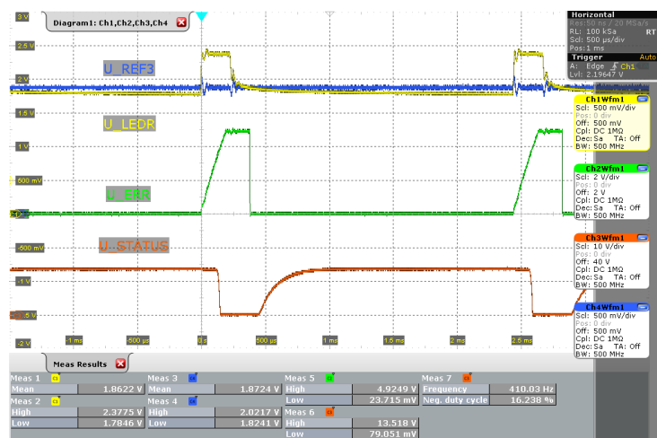
Obrázek 5.18 Změřené průběhy napětí na bloku detekce chyby typu nLED - 1 v režimu POS
