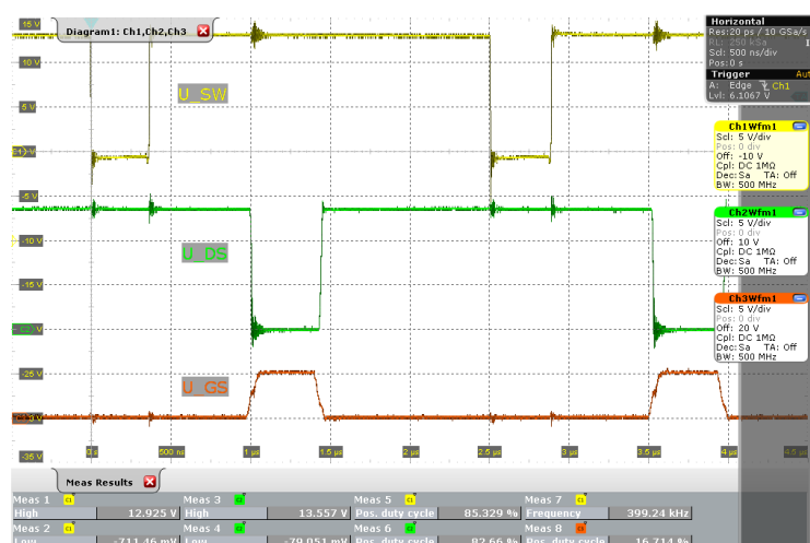
Obrázek 5.4 Změřené průběhy napětí v uzlech U_{SW} a U_{DS} při napájecím napětí U_{DRL} = 13,5\text{ V} v režimu buck-boost
