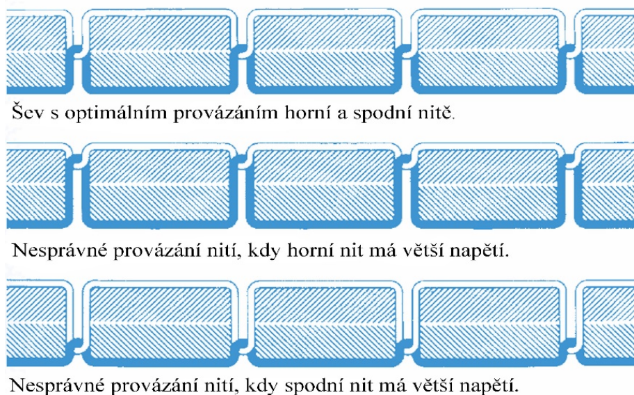
Obr. 2.2: Ukázka provázání nitě ve švu.
