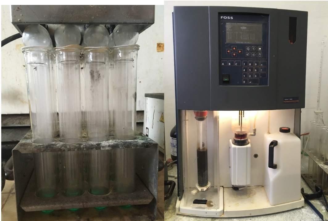
Obrázek 8 Mineralizační tuby (vlevo); přístroj Kjeltect™ 2400 Auto Analyzer (vpravo)
