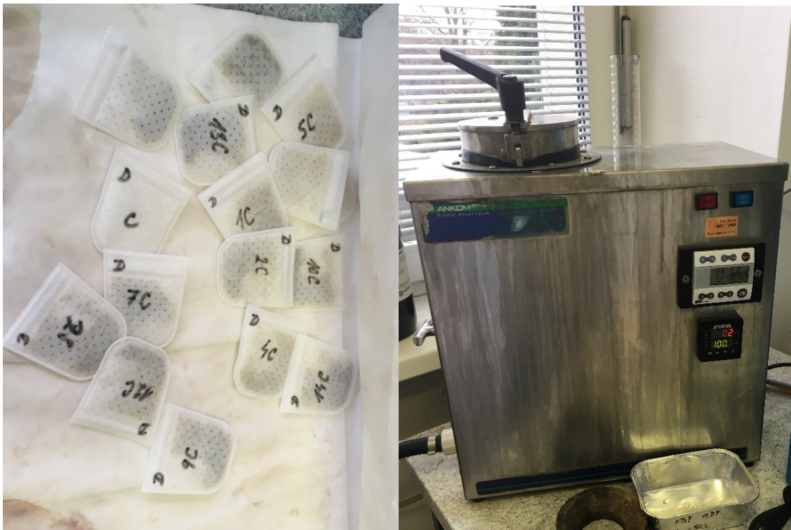
Obrázek 7 Vzorky po stanovení CF a louhování v acetonu (vlevo); ANKOM200 fibre analyzer (vpravo)
