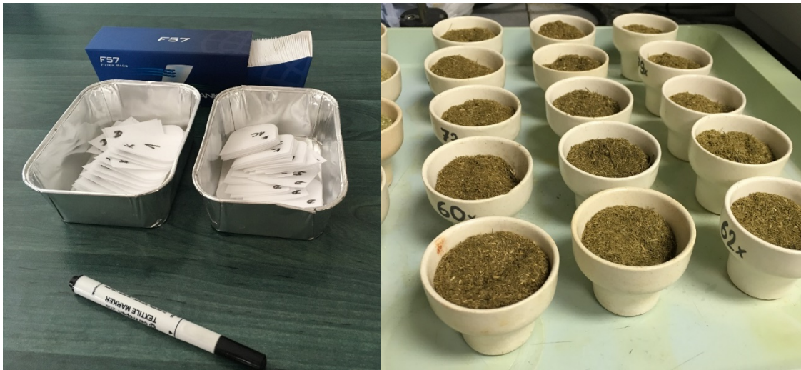
Obrázek 6 Sáčky F57 ke stanovení CF, NDF a ADF (vlevo); vzorky travní siláže se stanovenou sušinou
