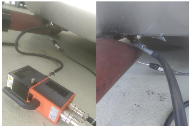
Obr. 18 Ředící zařízení bylo dvoudílné: řídicí modul Testo MD19-3E a jeho napojení do výfuku:
