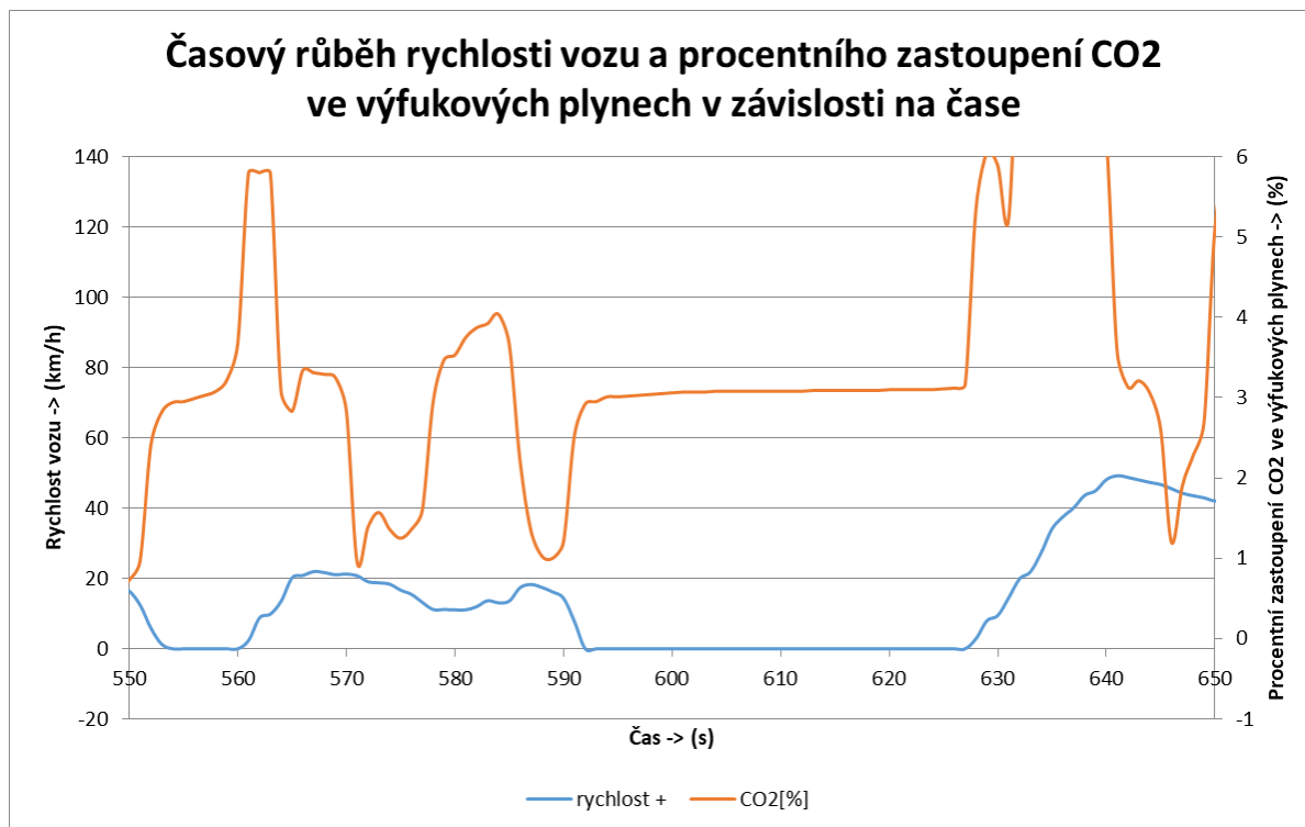
Graf 10: Synchronizovaný časový průběh rychlosti s procentním zastoupení CO2 ve výfukových plynech:
