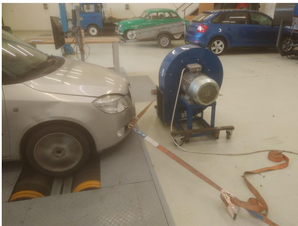
Obr. 27 Ventilátor FILCAR AL-1500/C zajišťoval chlazení:
