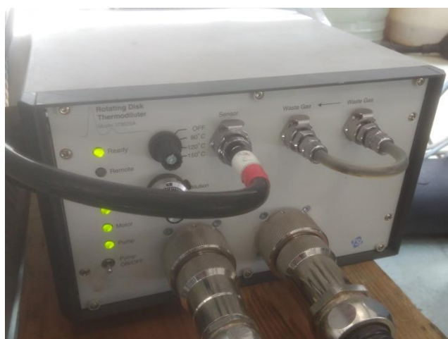
Obr. 19 Ředící zařízení bylo dvoudílné: vyhřívací člen TSI Rotating Disk Thermodiluter 379020A:
