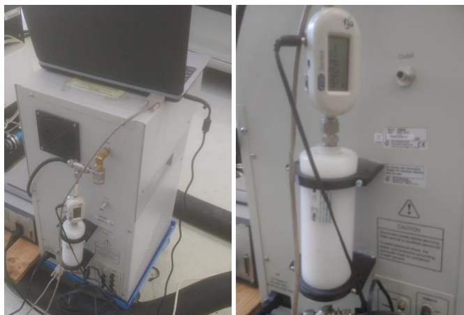
Obr. 20 Ředící zařízení: TSI HEPA Capsule Filter #1602051 s průtokoměrem TSI 4100 Series
