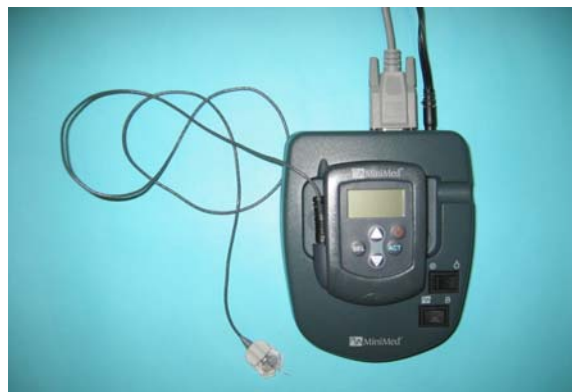
Obrázek 3 Komunikační stanice Com-Station s vloženým monitorem CGMS Gold, pro ilustraci je také zachycen kabel a senzor
