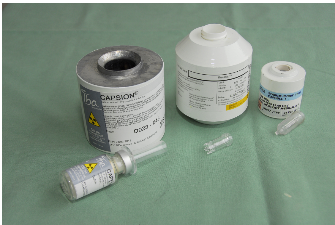
Obr. 2 – Pouzdra a olověné kryty na různé varianty kapslí
