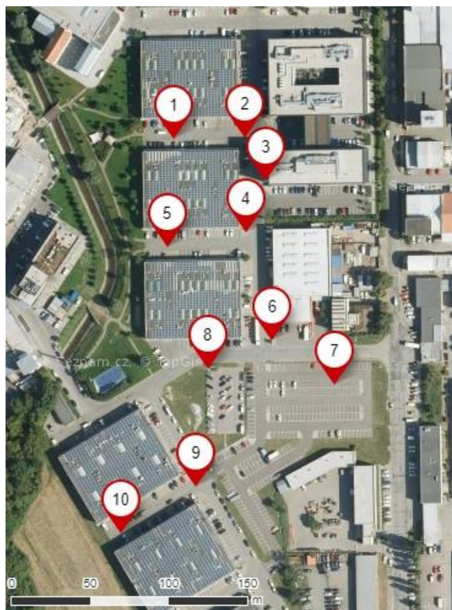
Obr. 8.8: Pozice umístění vývojových modulů v rámci testování MESH sítě
