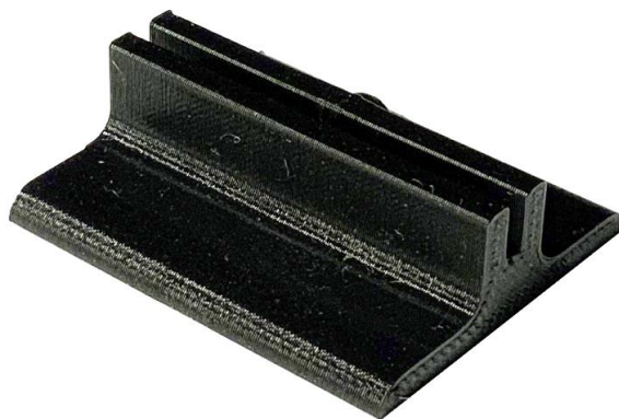
Obr. 5.4: Držák vývojového kitu vytištěný na 3D tiskárně
