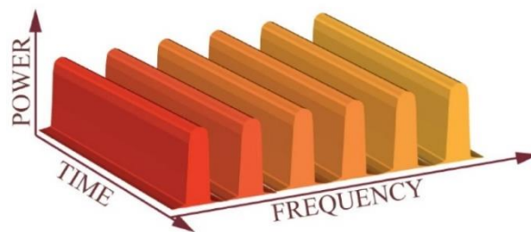
Obr. 3.8: Přístupová metoda FDMA (Frequency Division Multiple Access) [21]
