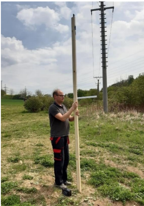
Obr. 8.3: Vysílací (vlevo) a přijímací (vpravo) přípravek pro měření komunikačního dosahu
