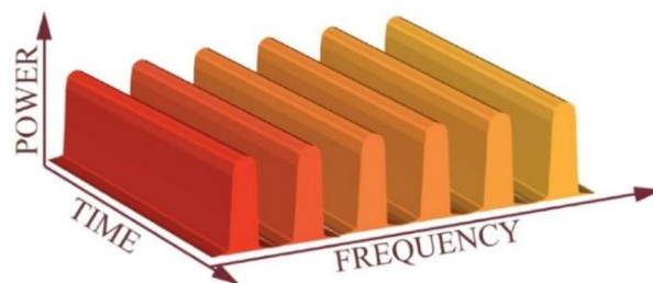
Obr. 3.8: Přístupová metoda FDMA (Frequency Division Multiple Access) [21]
