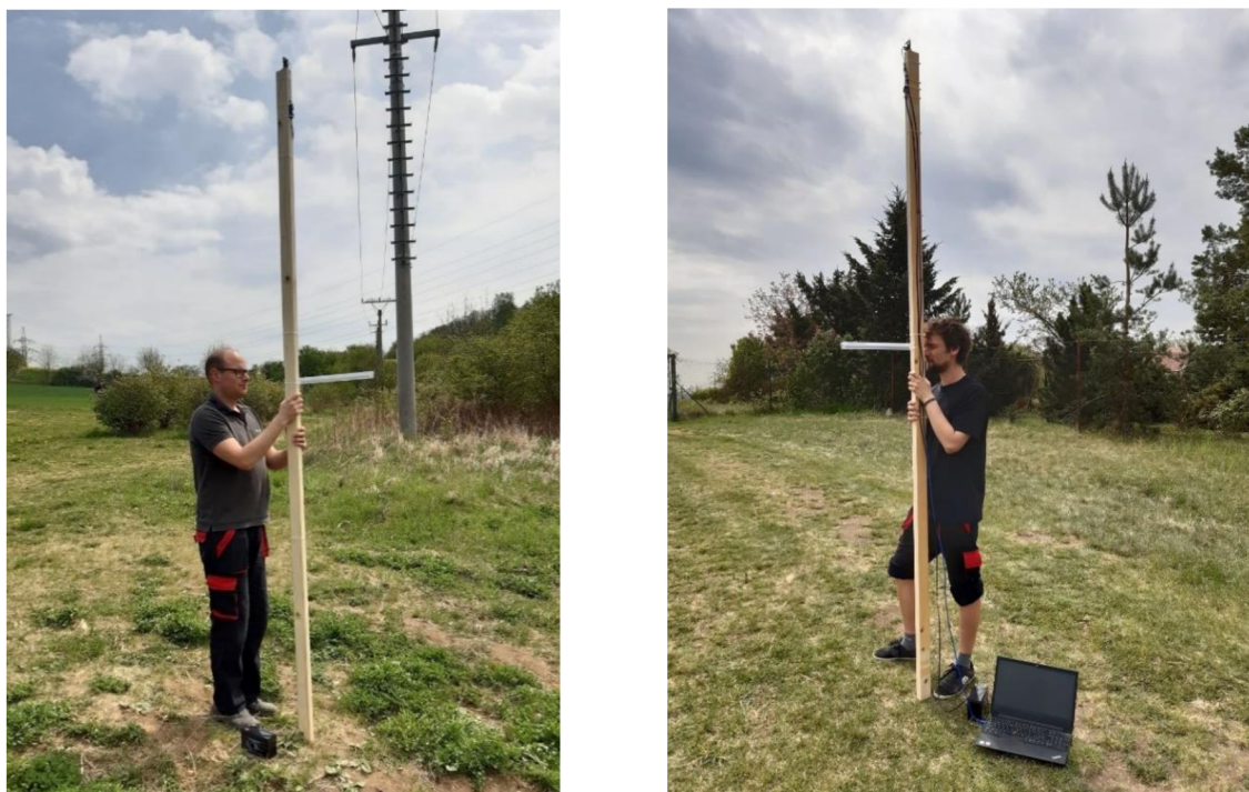
Obr. 8.3: Vysílací (vlevo) a přijímací (vpravo) přípravek pro měření komunikačního dosahu
