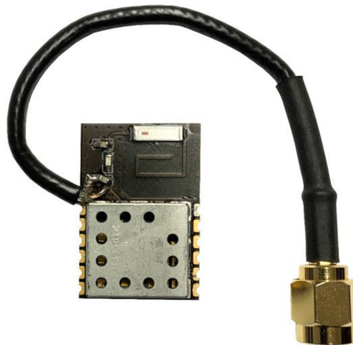
Obr. 4.9: Testovací kus komunikačního modulu upraveného pro impedanční přizpůsobení čipové antény
