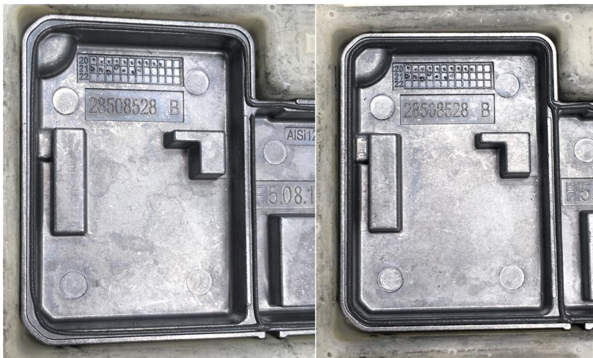
Obrázek 17: Ukázka špatně nanesených fipů
