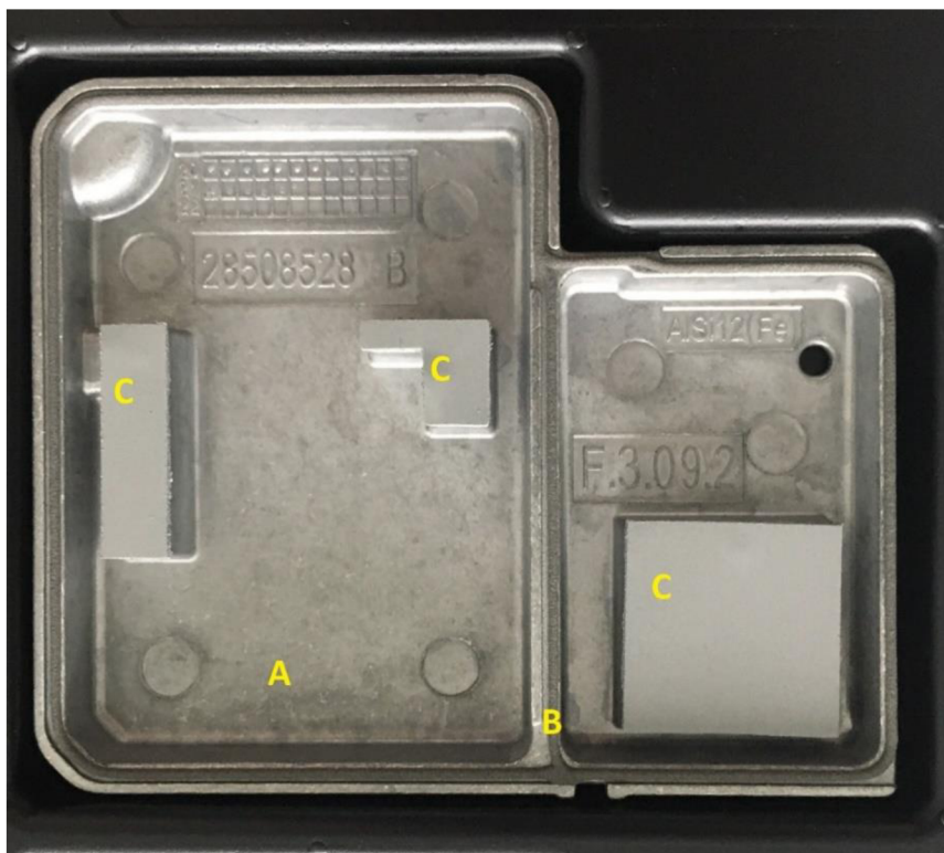
Obrázek 6: Hotová schránka adaptabilního radaru
