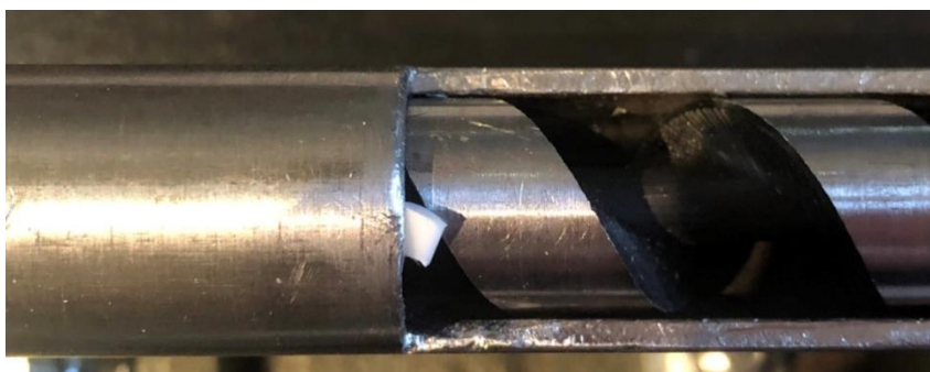
Obrázek 4.2: Zaseknutá peleta při demontáži násypky
