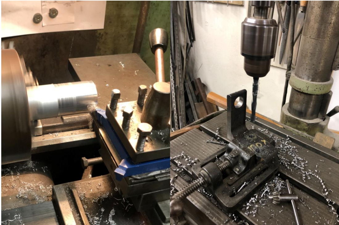
Obrázek 2.3: Obrábění dílců extrudéru
