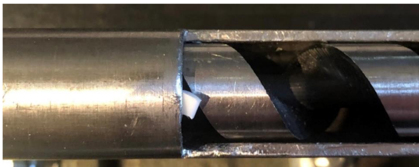
Obrázek 4.2: Zaseknutá peleta při demontáži násypky
