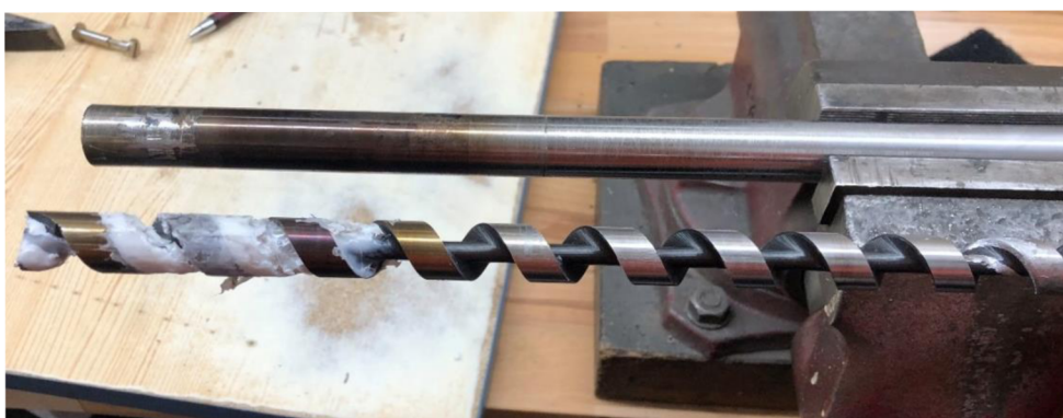
Obrázek 4.8: Demontovaný vrták a komora extrudéru
