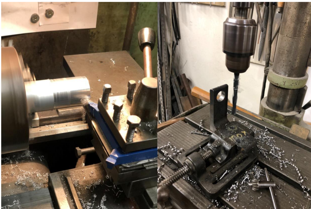
Obrázek 2.3: Obrábění dílců extrudéru
