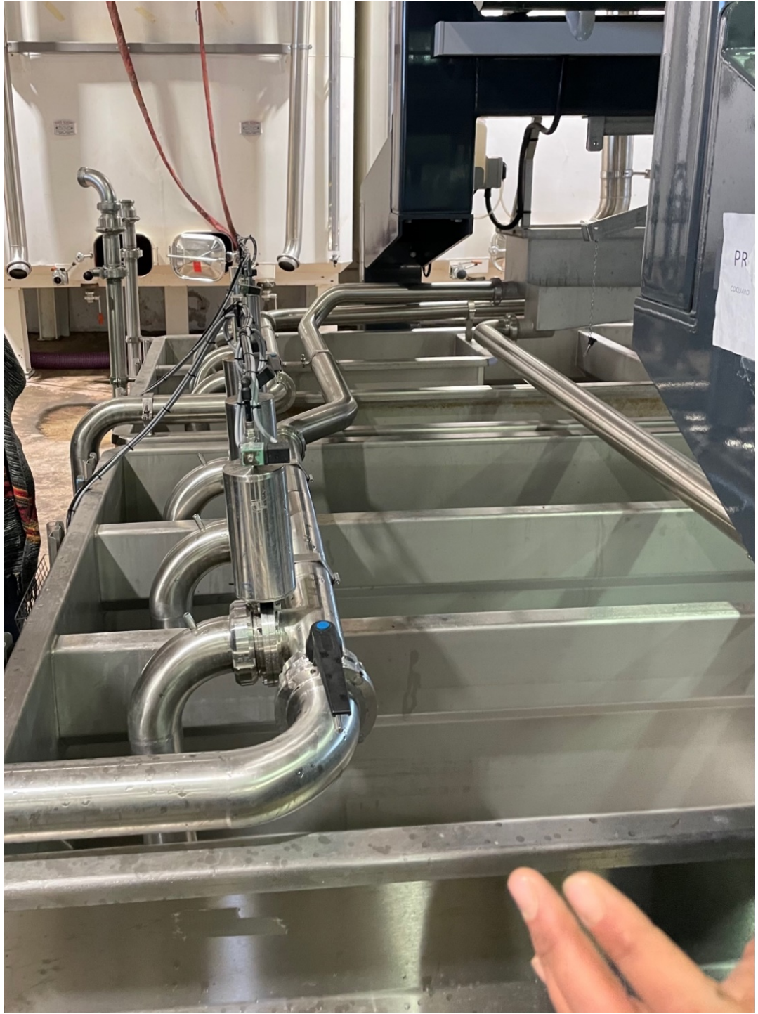
Příloha 10: Otevřená nádrž (beton), ve které se separuje šťáva tekoucí z lisu a kde se přidává oxid siřičitý.
