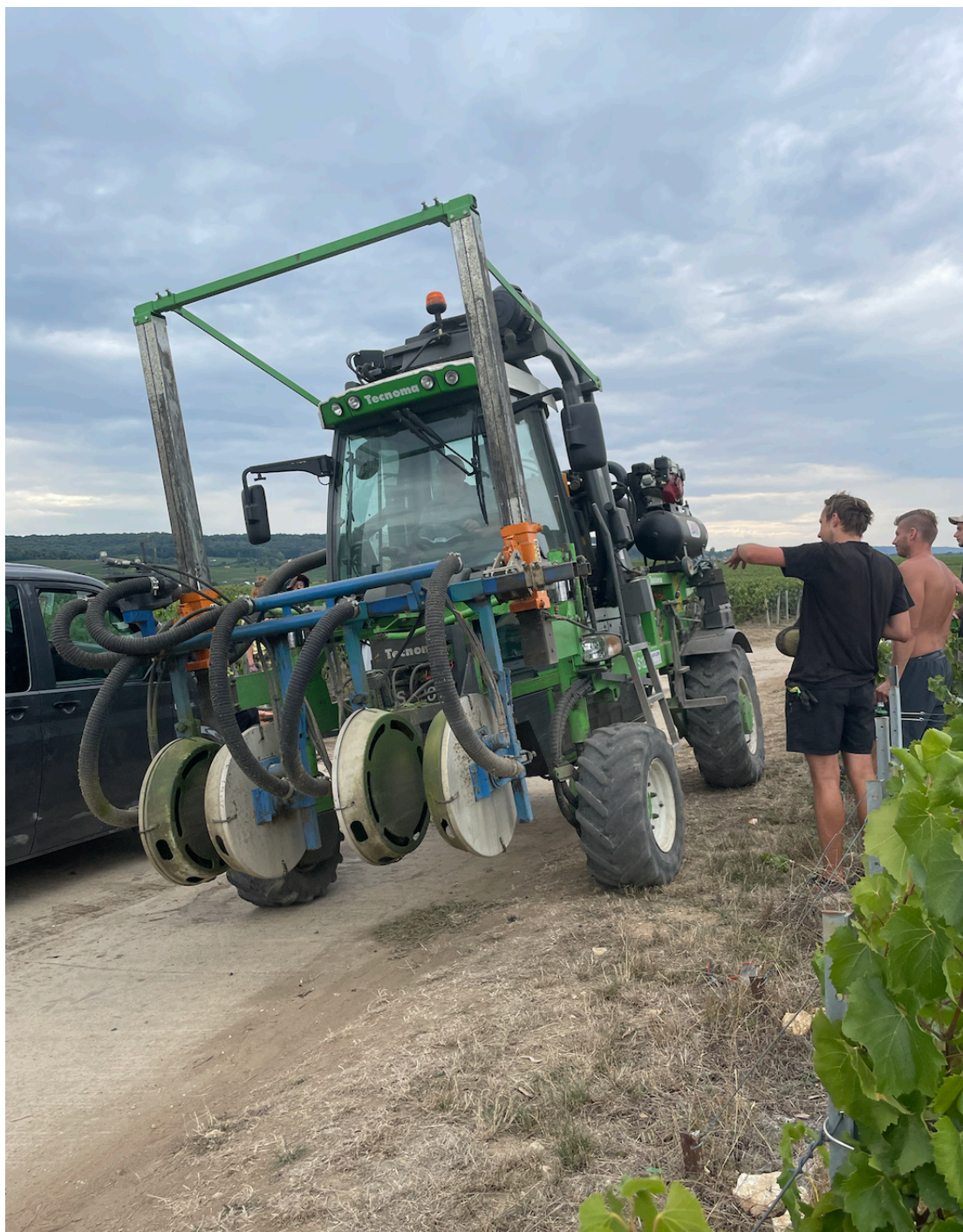
Příloha 12: Speciální traktor určený k metodě effeuilleuse, tedy ofoukání přebytečných listů před zahájením sklizně.
