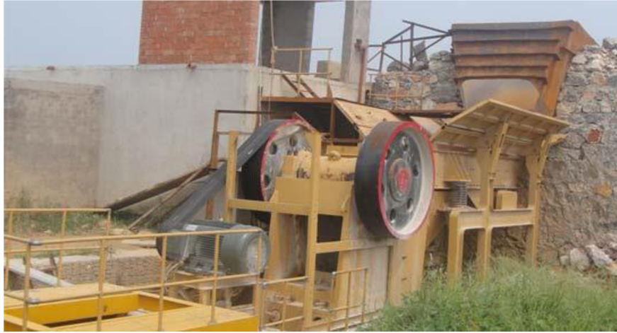
Obr. 19 Jednovzpěrný čelistový drtič poháněný elektromotorem s podavačem [18]
