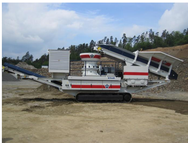
Obr. 17 Mobilní drtící jednotka MCU 7UC-2C firmy DSP Přerov [16]
