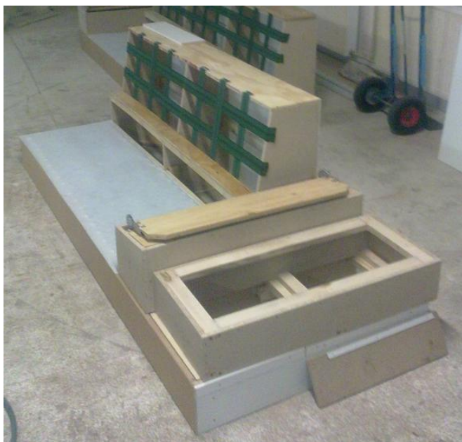
Obr.25 Příklad dřevěné konstrukce čalouněného výrobku
