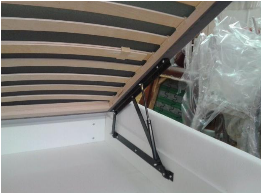
Obr.42 Detail kotvení a způsobu uchycení rámu
