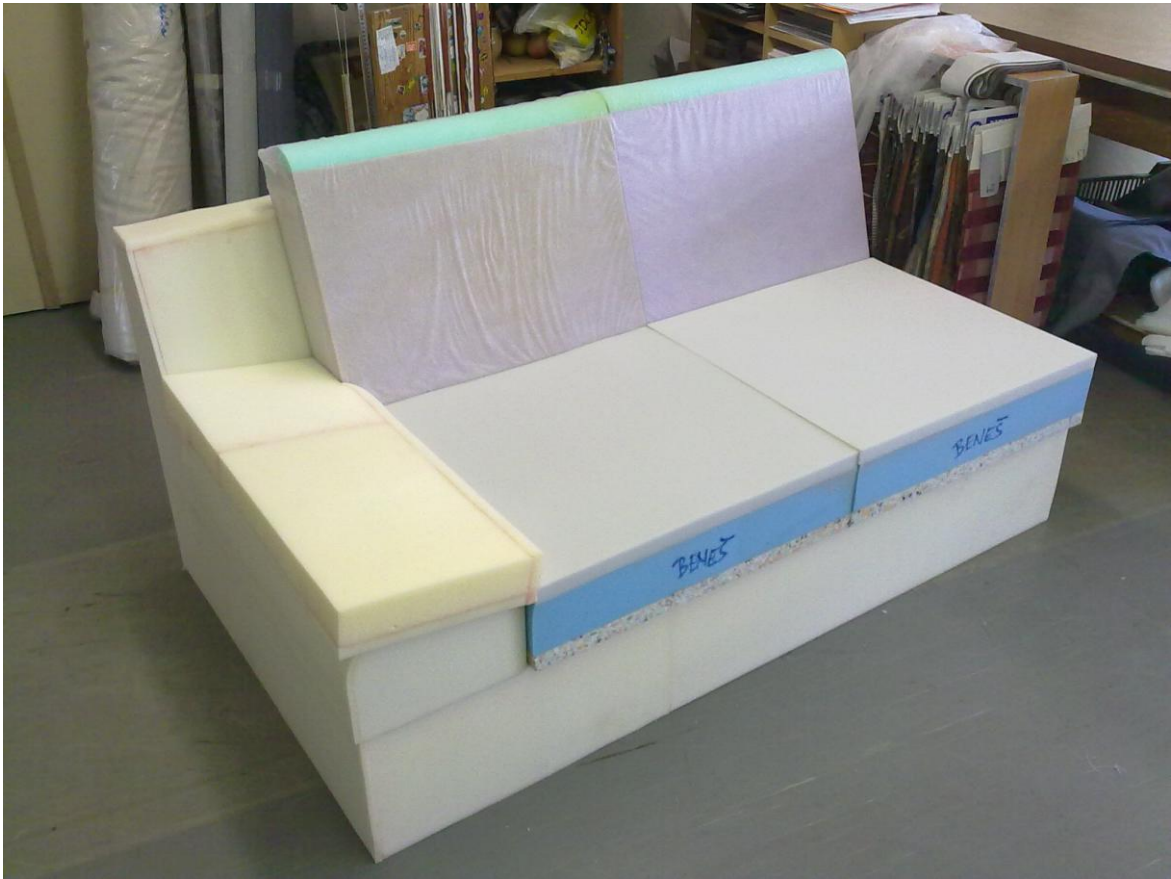
Obr.30 Olepená konstrukce čalouněného výrobku připravená na potažení
