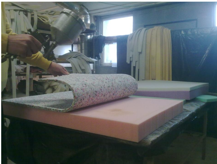
Obr.28 Slepování vrstev polyuretanových pěn nástřikem polyuretanového lepidla pneumatickou nanášecí pistolí
