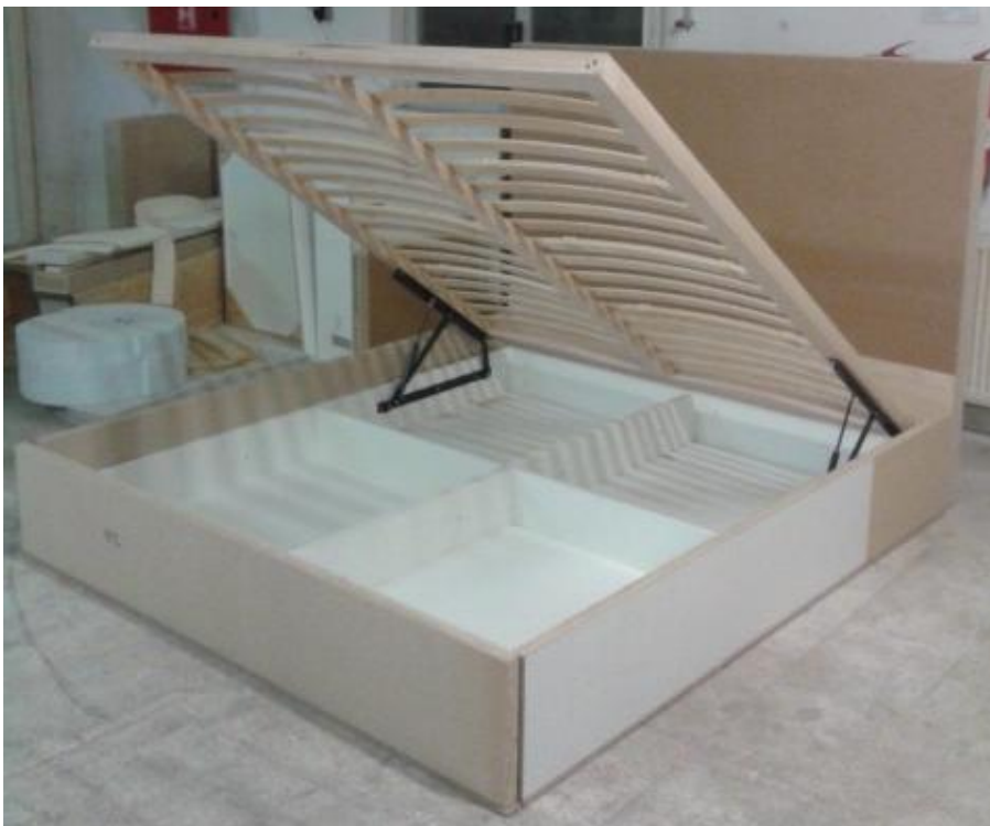
Obr.40 Konstrukce dvoulůžka před olepením pěnovými materiály
