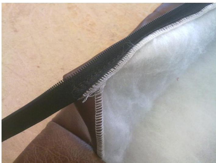
Obr. 33 Detail všití zipu a podšívání usní rounem technologií Overlock
