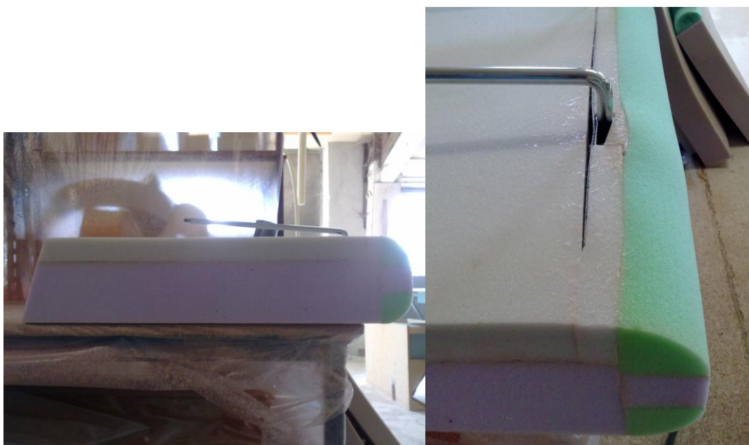
Obr.28 Slepování vrstev polyuretanových pěn nástřikem polyuretanového lepidla pneumatickou nanášecí pistolí
