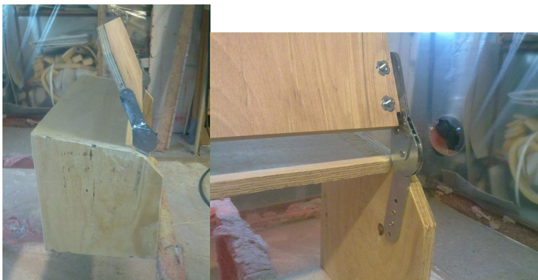
Obr.26 Vnitřní překližková konstrukce područky s ráčnovým kováním
