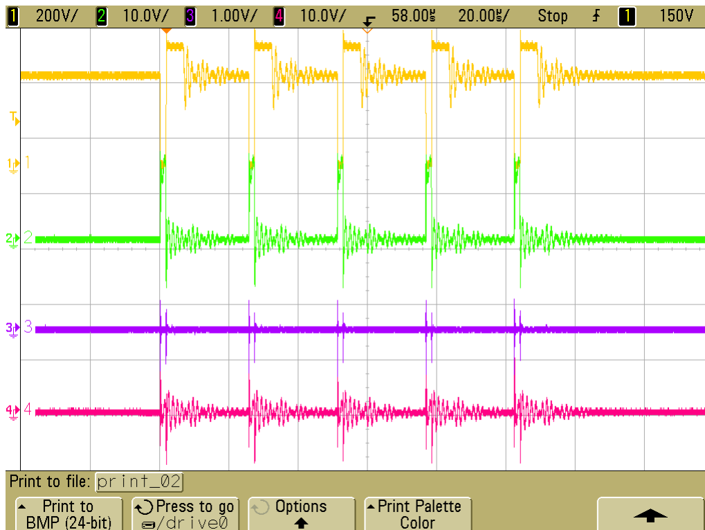
Obr. 42 Úsporný režim, série 40 kHz pulzů ( V_{out}=19,4 V; I_{out}=0,2 A)
